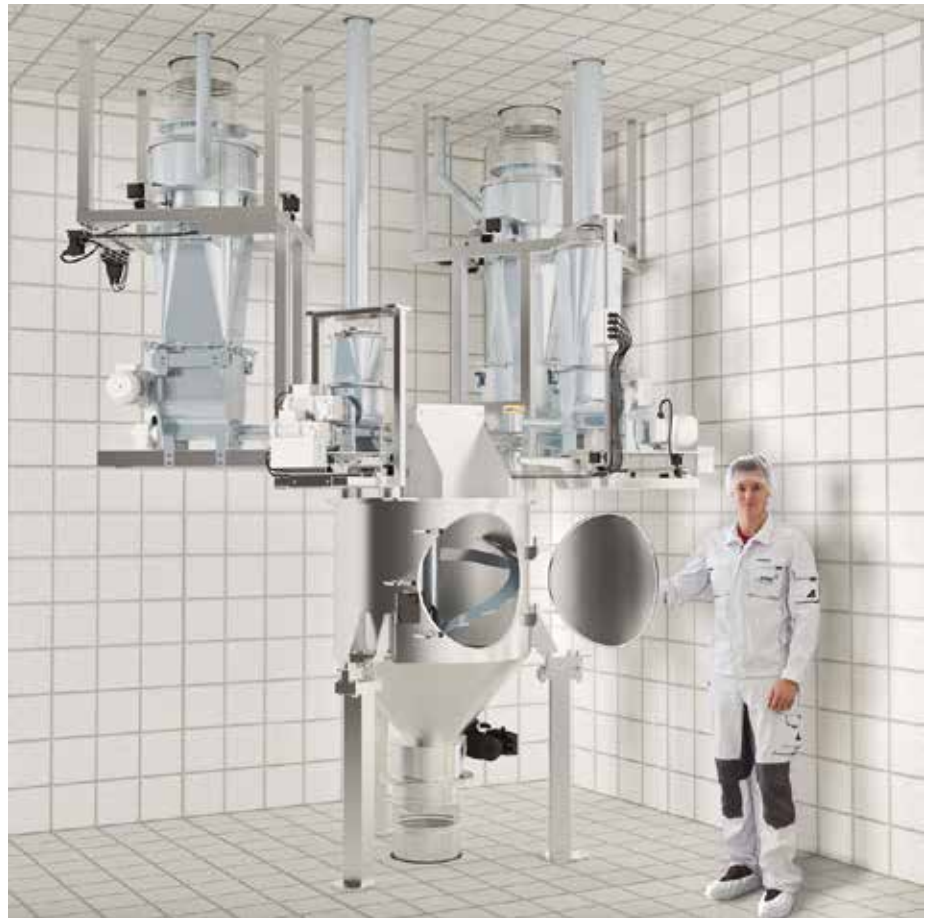
Abb. 5: Der amixon Kontinuierlich-Mischer mit vier gravimetrisch arbeitenden Dosiersystemen. Der Mischer ruht auf Wägezellen. Einfüllstutzen und Austragsstutzen sind mit flexiblen Manschetten versehen. Die Verschlussarmatur des Mixers wird so gesteuert, dass der Füllgrad im Mischer konstant bleibt. Dieser Präzisionsmischer kann auch chargenweise genutzt werden (Abb.: amixon)
