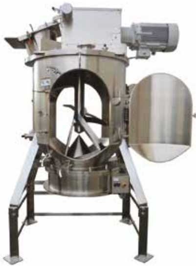
Abb.: 4: Besonders gute Zugänglichkeit: CleverCut Inspektionstür mit tottraumfreier Dichtung ist dauerhaft gas- und wasserdicht. Die O-Ringdichtung kann über Konturgrenzen hinweg geführt werden. Sie dichtet dauerhaft, gasdicht, praktisch tottraumfrei nah am Produkt und weist eine lange Lebensdauer auf (Abb.: amixon)
