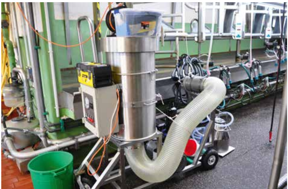
Sterivent-Filtereinheit für 500 m 3 /h Überdruck-Sterilluft. Anschlussleistung ca. 0,2 kW. Die Luftreiniger in einem Edelstahlgehäuse (Edelstahl 304) bestehen aus einem Vorfilter, einem Gebläse und dem Sterilfilter (Hepa-Filter). Vorfilter: Klasse G3 nach DIN EN 779. Sterilfilter: aktive Oberfläche 5,5 m 2 . Luftgeschwindigkeit 1,5 cm/s. Abscheidegrad 99,997 %. Brandschutzklasse: F 1. Kaskadenschaltung mehrerer Einheiten möglich. Vorbereitet zum Anschluss an die Prozessleittechnik. Unten rechts im Bild das Behältnis für die mit keimfreier Luft gemolkene Milch
