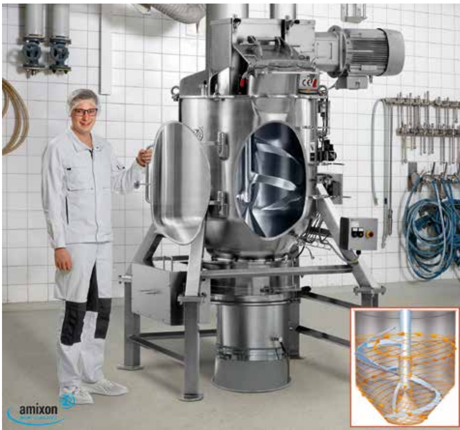
Abb. 2: Das KoneSlid Mischprinzip arbeitet unabhängig vom Füllgrad. Dieser kann von ca. 10 % bis 100 % variieren (Abb.: amixon)
