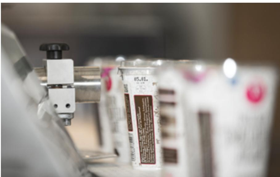
Die Drucker der Linx 89er Serie können abhängig vom Systemtyp zwischen einer und fünf Zeilen in Schriftgrößen von 1,8 bis 20 Millimetern drucken (Foto: Bluhm Systeme)
