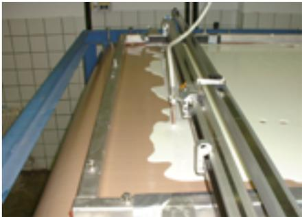
**Optional kann der EL-A Kontaktbandtrockner mit einer Durchlaufwaschanlage ausgerüstet werden (Foto: EL-A)**
