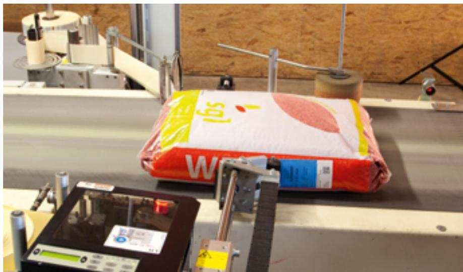
Der Etikettenspender Alpha HSM ist für staubige Umgebungen ausgelegt (Foto: Bluhm Systeme)
