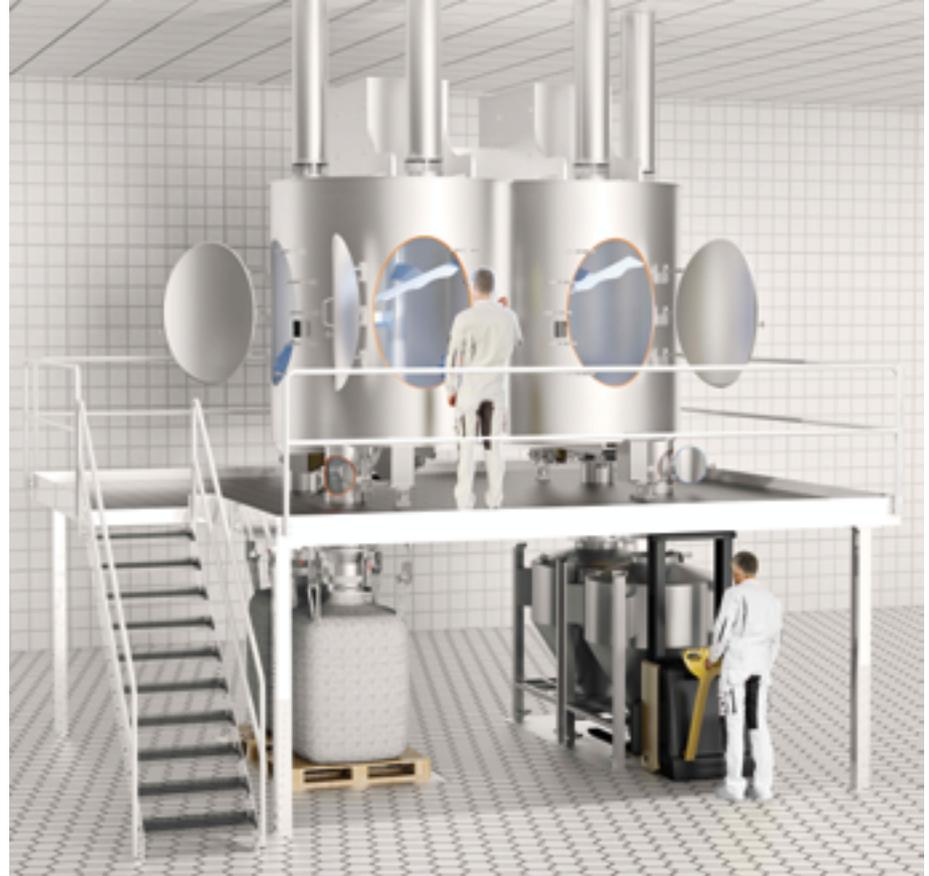
**Abb. 2.: Doppelwellenmischer mit 10 m<sup>3</sup> nutzbarem Volumen mit 4 tottraumfreien Austragsorganen, die zeitlich fungieren. Der Mischer weist 8 CleverCut Inspektions-türen auf (Abb.: amixon)**
