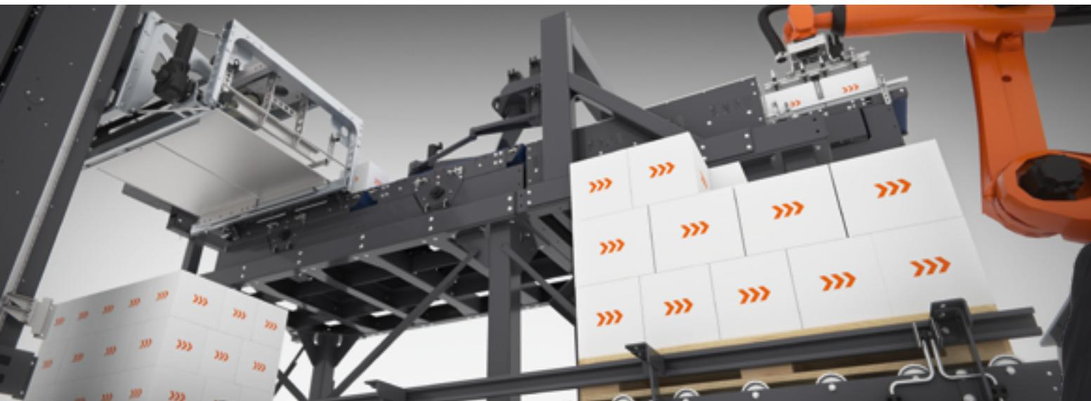
Der Hochleistungs-Lagenpalettierer HLP 6000 ist auf 4 m<sup>2</sup> Standfläche extrem kompakt gebaut und zeichnet sich dennoch durch enorme Flexibilität aus (Foto: TRAPO)
