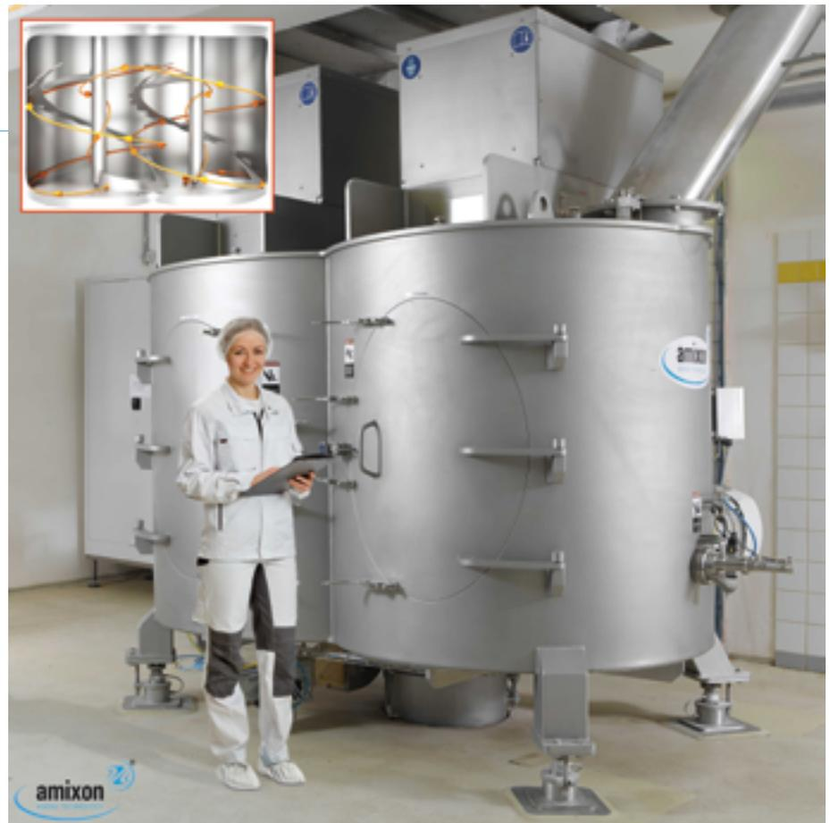
Abb. 1: Doppelwellenmischer und Strömungsprinzip (Abb.: amixon)
