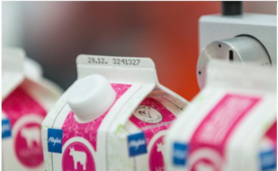
Die Linx-Drucker verarbeiten eine spezielle Tinte, die eine zuverlässige Codierung auf leicht feuchten Oberflächen gewährleistet (Foto: Bluhm Systeme)
