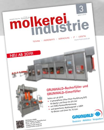
8-bahniger Becherfüller FOODLINER 20.000 UC mit einer garantierten Entkeimungsrate von mind. log 4 (Foto: Grunwald)
