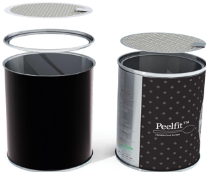
Die Peelfit Dose ist zum einen vollständig bedruckbar. Zum anderen wird unter Verwendung von „Direct Heat Sealing“ (DHS), einem direkten Heißklebverfahren, eine abziehbare Folie direkt auf einen aufgeschmolzenen Metallring auf der Innenseite des Dosenkörpers geklebt (Foto: Crown)
