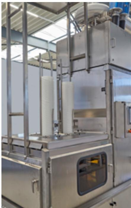
**Das doppelte Eimermagazin sorgt für Flexibilität in der Produktion**
