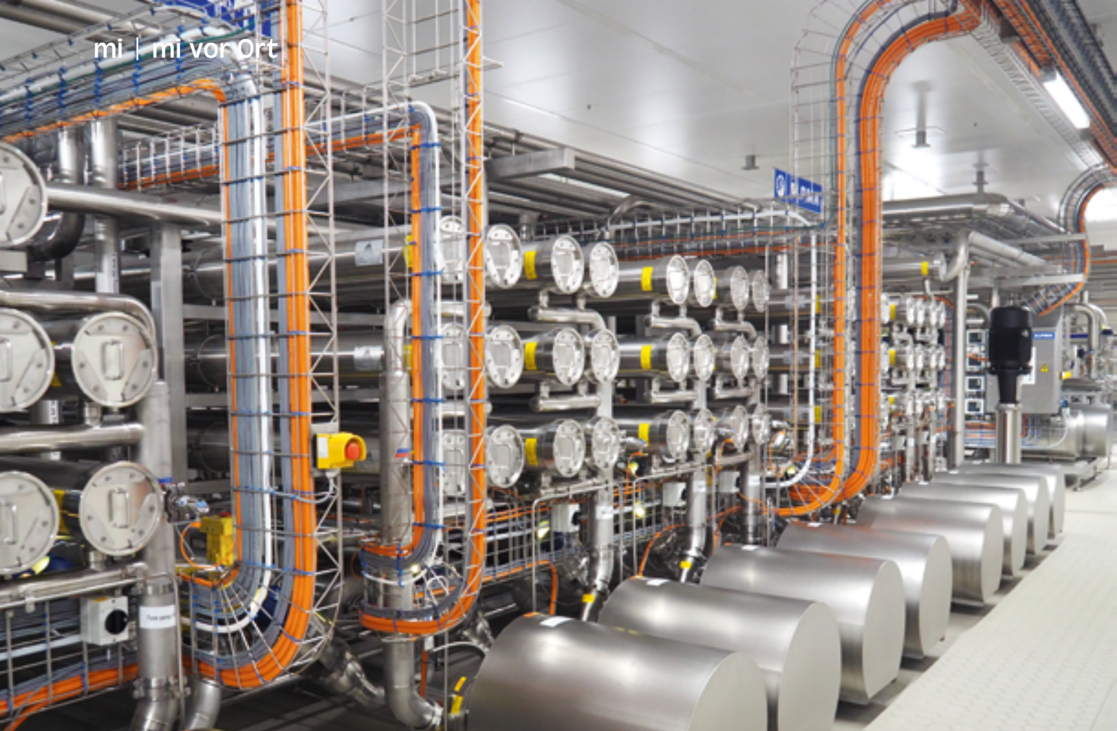
Die UO-Anlage ALPMA RO High in Gerkesklooster hat eine Membranfläche von über 10.000 m 2 (Foto: mi)
