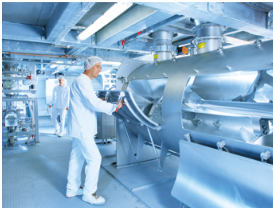
Mit ihrem WIP-System ist die neue Anlage bei SternMaid auf eine Nassreinigung bei Produktwechseln ausgelegt (Foto: SternMaid)
