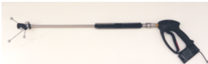
Bild 3: Modifizierte Hochdrucklanze für die virtuelle Reinigung (Quelle: Hochschule Albstadt-Sigmaringen)
