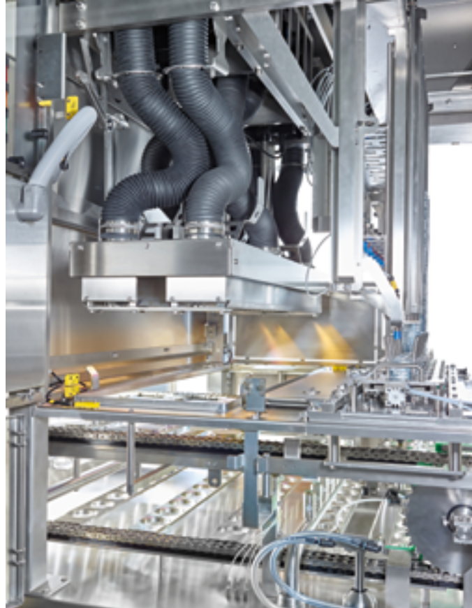
Zweifache pulsed light Hochleistungs-UV(C)-Becherentkeimung
