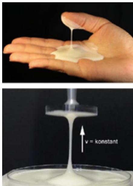
Abbildung 3: Klassifizierung des Fadenzugs von gesäuerter Milch mit der Fingerprobe (oben) und die Bestimmung der Abrisslänge bei konstanter Geschwindigkeit (unten)
