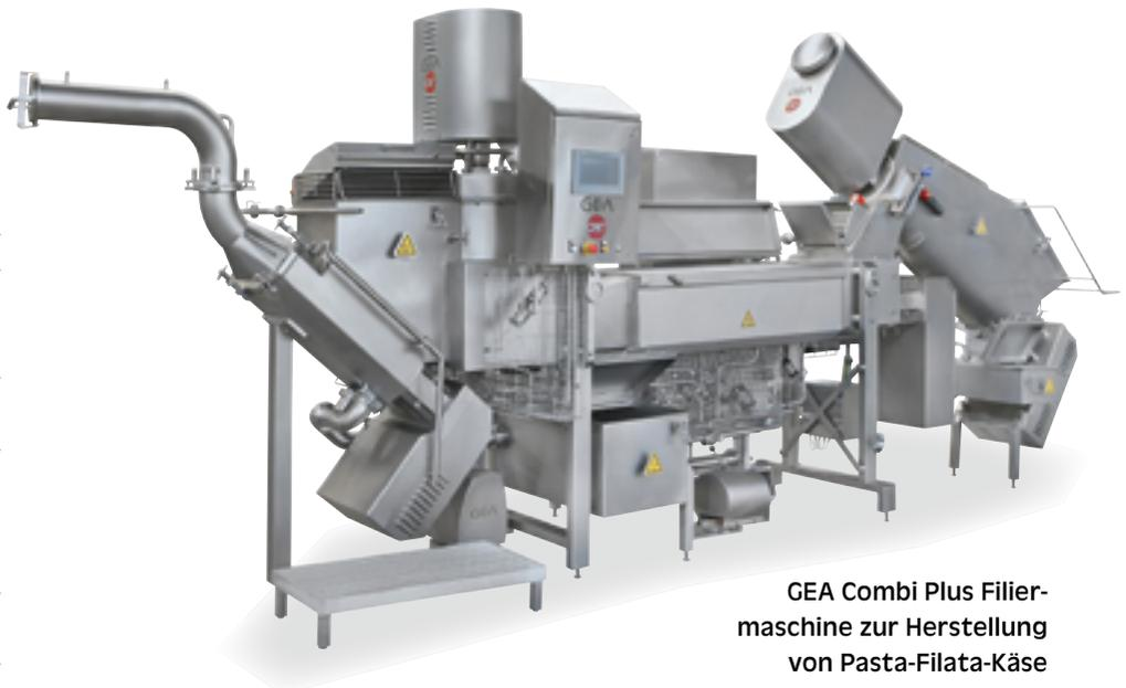
**GEA Combi Plus Filiermaschine zur Herstellung von Pasta-Filata-Käse**
