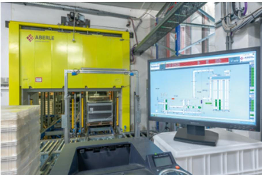
In dem Modernisierungsprojekt in Feldkirchen wurden ein Materialflussrechner und das Materialflussmodul PMS-M aus dem Prozessmanagementsystem von Aberle installiert und in die SAP-Kommunikationsstruktur SAP eingebunden (Foto: Aberle)
