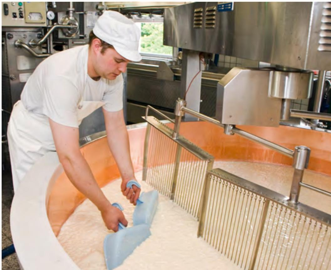
**Plastikteile, Metallspäne oder Absplinterungen von Rühr- und Schneidemaschinen können auch während der Produktion in das Erzeugnis gelangen**
