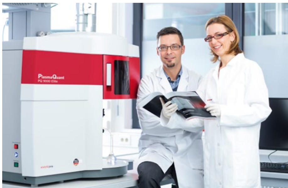
High-End-Analytik, hier ein optisches Emissionsspektrometer von Analytik Jena, erlaubt unter anderem gesicherte Aussagen über die Herkunft von Rohstoffen (Foto: Analytik Jena)
