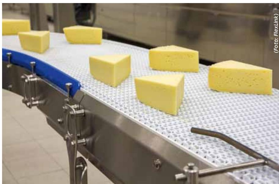
**D**as neue WLX Fördersystem der Firma FlexLink Systems GmbH bietet viele Vorteile für moderne Molkereibetriebe. Es handelt sich um ein zertifiziert hygienisches und sicher zu handhabendes System, das ohne großen Zeitaufwand montiert, demontiert und immer wieder umgebaut werden kann. Eine schnelle, effektive und reproduzierbare Reinigung ist kein Problem. Durch standardisierte Komponenten hat das System eine hohe Flexibilität und eine lange Lebensdauer.
