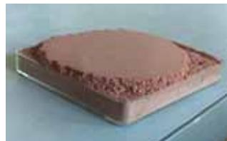
Pulver wurde in ein Gefäß gegeben, glatt gestrichen und in der Mitte mit einem Wägestück von 200 g belastet. Der Wassertropfen durfte dann nur in diesem Bereich abgesetzt werden.
