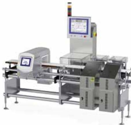
**Das neue Kombisystem CM35 AdvancedLine vereint eine dynamische Kontrollwaage und einen Metalldetektor in einem Gerät (Foto: Mettler-Toledo)**
