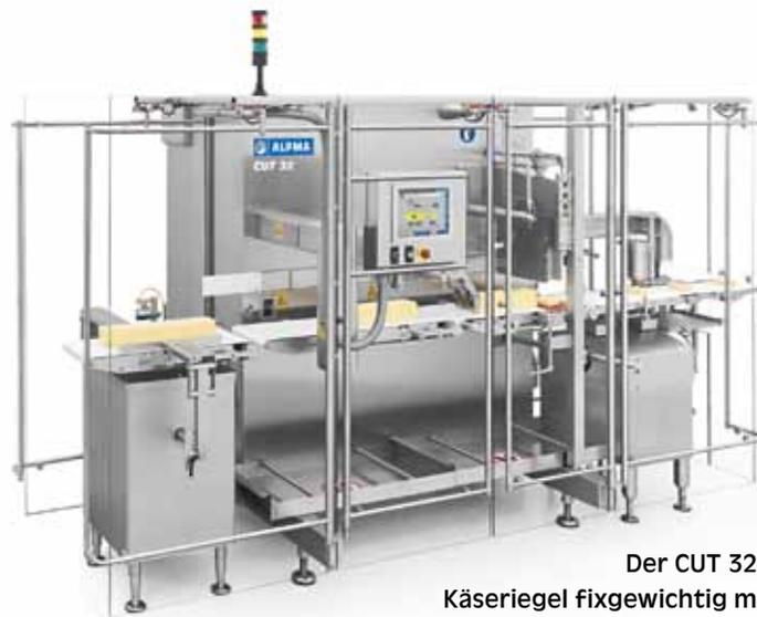
Der CUT 32 portioniert Käseriegel fixgewichtig mit optimaler Ausbeute (Foto: ALPMA)
