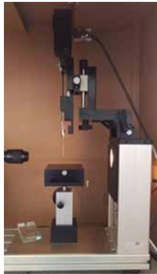
In der Mitte erkennt man den Probentisch, auf den die Pulverprobe platziert wird, die von oben her abzeigende Kapillare, aus der der Wassertropfen kommt und die möglichst dicht oberhalb der Pulveroberfläche für die Tropfenabgabe positioniert wird, sowie auf der linken Seite die Videokamera.
