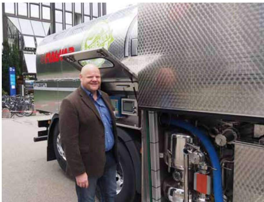
abo-Magyar nutzt die Optitool Tagung zur Vorstellung eines MSW, der in drei Kammern 16.500 l Milch fasst und mit einer akkubetriebenen Ejektor-Milchannahme V 80 und der Milchmessanlage Bartec 3003 ausgestattet ist. Die G MAGYAR Gruppe, zu der abo-Magyar seit 2004 gehört, baut lt. René Klusmann (Foto) seit 6 Jahren akkubetriebene Sammelfahrzeuge und hat bereits 150 solche Fahrzeuge verkauft. Unter optimalen Voraussetzungen kann die Diesel-Einsparung mit 4 bis 4,5 l pro Betriebsstunde des Milcheinzugs angesetzt werden. (Foto: mi)
