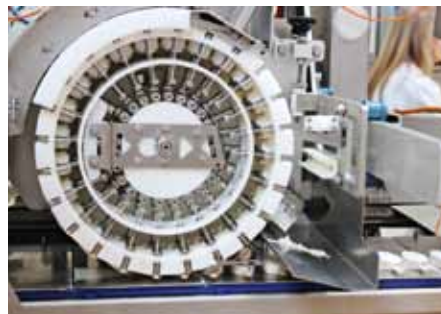
Das neue Tetra Pak Extrusionsrad für Stick-Eiscreme-Produkte
