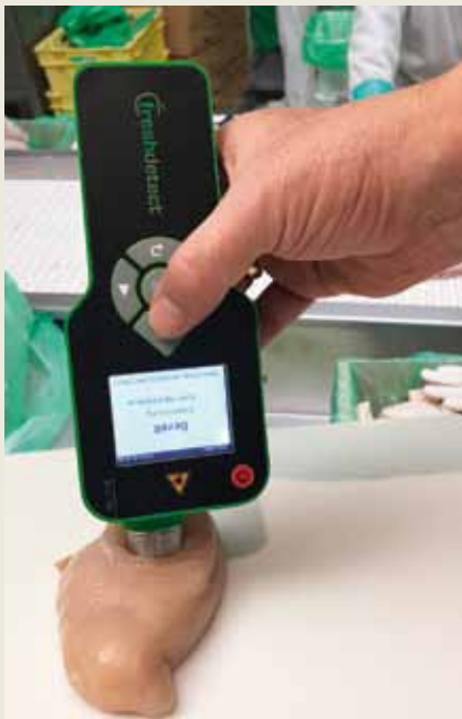
Mit dem mobilen Handmessgerät BFD-100 kann jetzt auch die Gesamtkeimzahl von Hähnchenbrust bestimmt werden.
