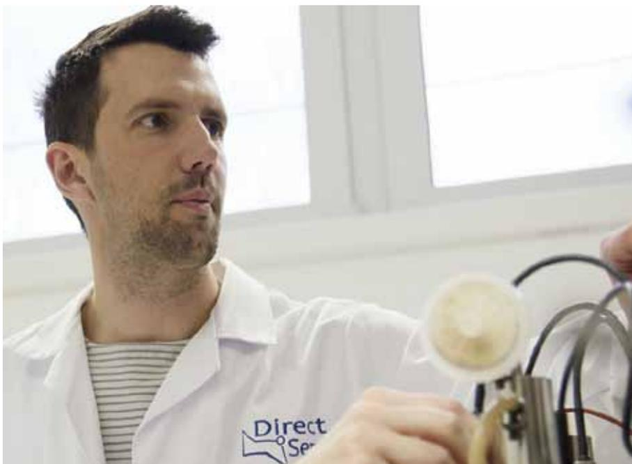
Forscher und CEO Dr. Sigmund erklärt das elektrochemische Prinzip seiner Biosensor-Technologie: Das hochspezifische Enzym erzeugt einen – direkt messbaren – Stromfluss in Abhängigkeit von der Menge an Substrat
