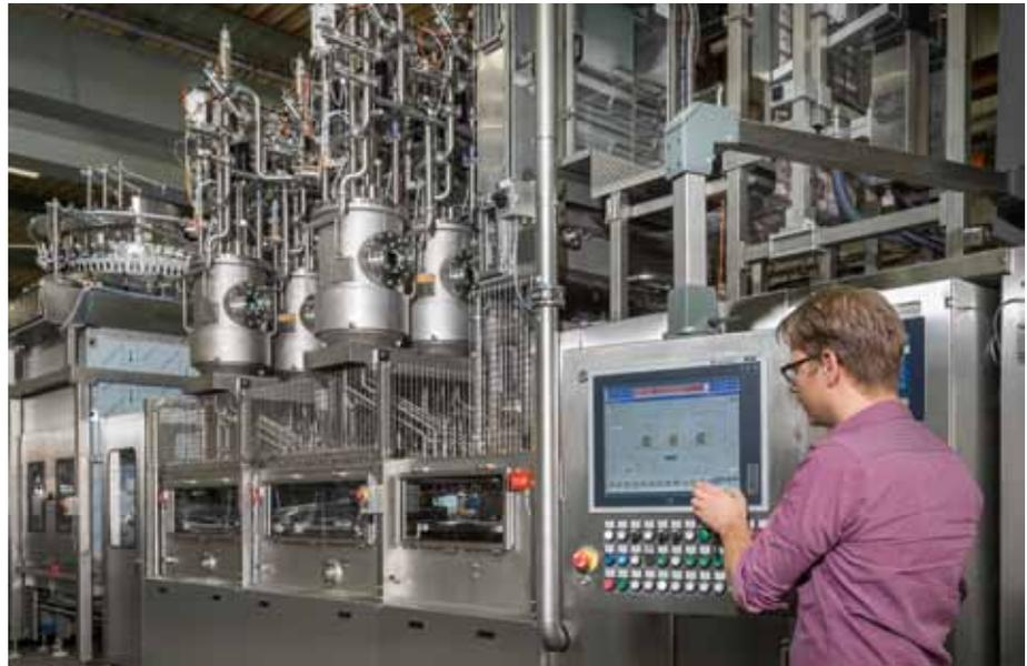
**Teilansicht einer aseptischen Form-, Füll- und Verschließmaschine von Finnah Packtec, die Präzisionstechnik mit hohem Bedienkomfort vereint (Foto: Finnah Packtec)**
