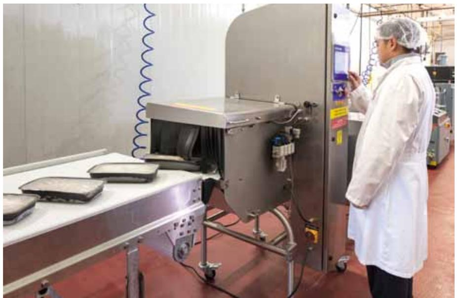
**Teilmassenbestimmung von Artikeln mit unterschiedlichen Abfüllzonen durch ein Röntgeninspektionssystem**
