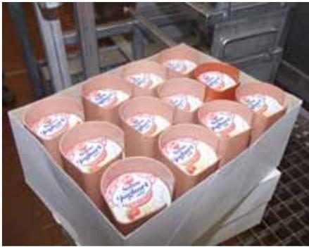
Die vorbereiteten Platinen für die Joghurt-Becher, sie werden allerdings mit der bedruckten Seite nach unten in die Maschine eingelegt – Fehler werden dann erst erkannt, wenn die Becher fertig sind
