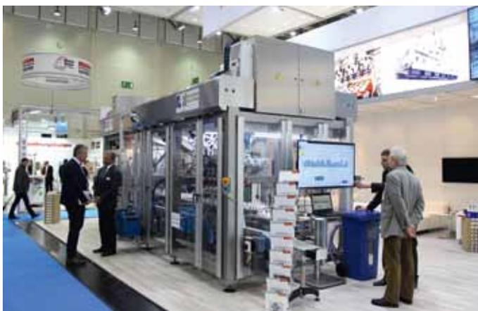
A+F hatte eine SetLine auf dem Messestand, die mit dem A+F Condition Monitoring System ausgestattet war (Foto: mi)
