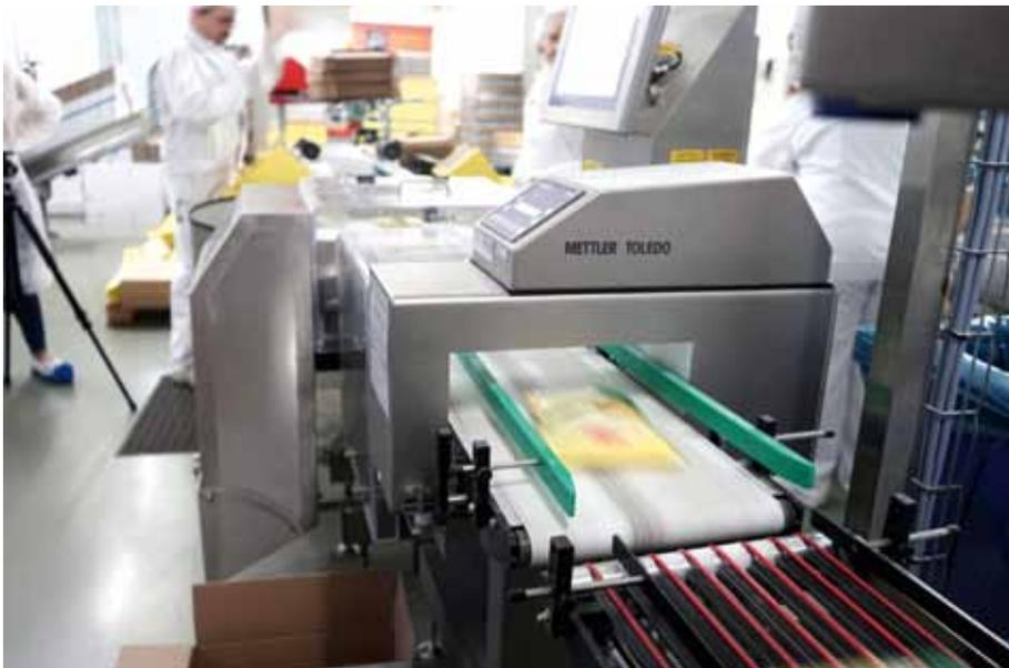
**Fremdkörpererkennung und Vollständigkeitskontrolle von geriebenem Käse mittels Metallsuchgerät und Kontrollwaage in einem Kombigerät**
