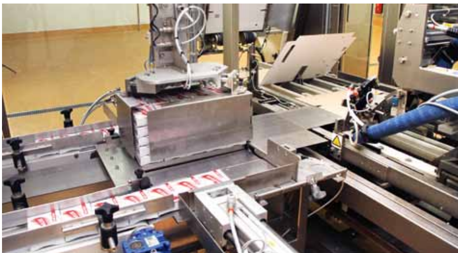
Diese Linie bei Bielmelk ist dazu bestimmt, Butterstücke in einer Größe von 100 bis 250 g zu verpacken und zudem die weitere Verpackung in Kartons zu übernehmen (Foto: Trepko)
