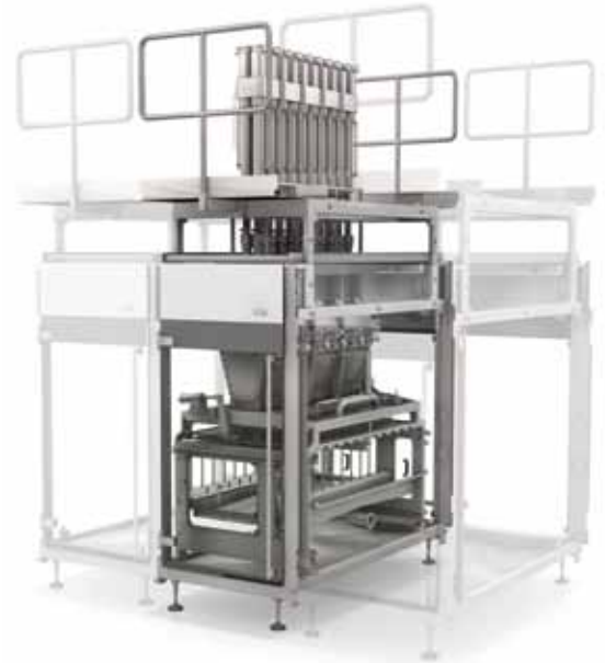
Der neue KHS-Stückchendoseur für funktionale Milchdrinks ermöglicht die schonende Füllung von Stückchen mit bis zu 10 x 10 x 10 mm Kantenlänge (Foto: KHS)
