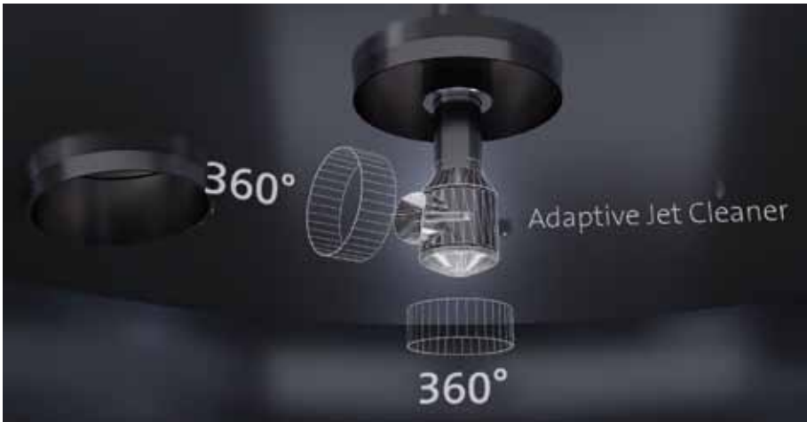
Abbildung 2: Adaptive Jet Cleaner mit zwei motorisch frei drehbaren Achsen und separater Fluidleitung, somit keine Hygienrisiken aufgrund durchströmter Getriebe/Lager. Ermöglicht maximalen Handlungsspielraum für bedarfsgerechte Tankreinigung
