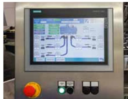
Die Steuerung des Schmelzgeräts ist in das HMI der Hauptmaschine eingebunden
