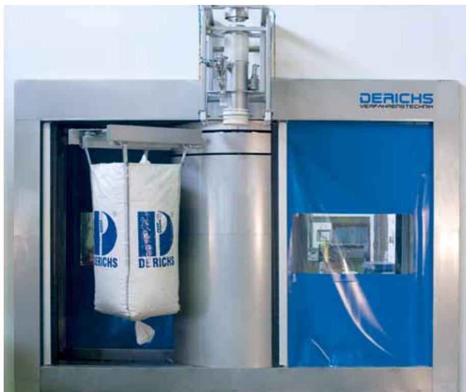
Befüllung, Schleusung und Absetzen können bei der Derichs Big-Bag-Befüllstation LFBR in einem kompakten Gerät integriert werden, so dass eine komplette funktionsfähige Einheit entsteht, die einfach in den Produktionsprozess integriert werden kann (Foto: Derichs)
