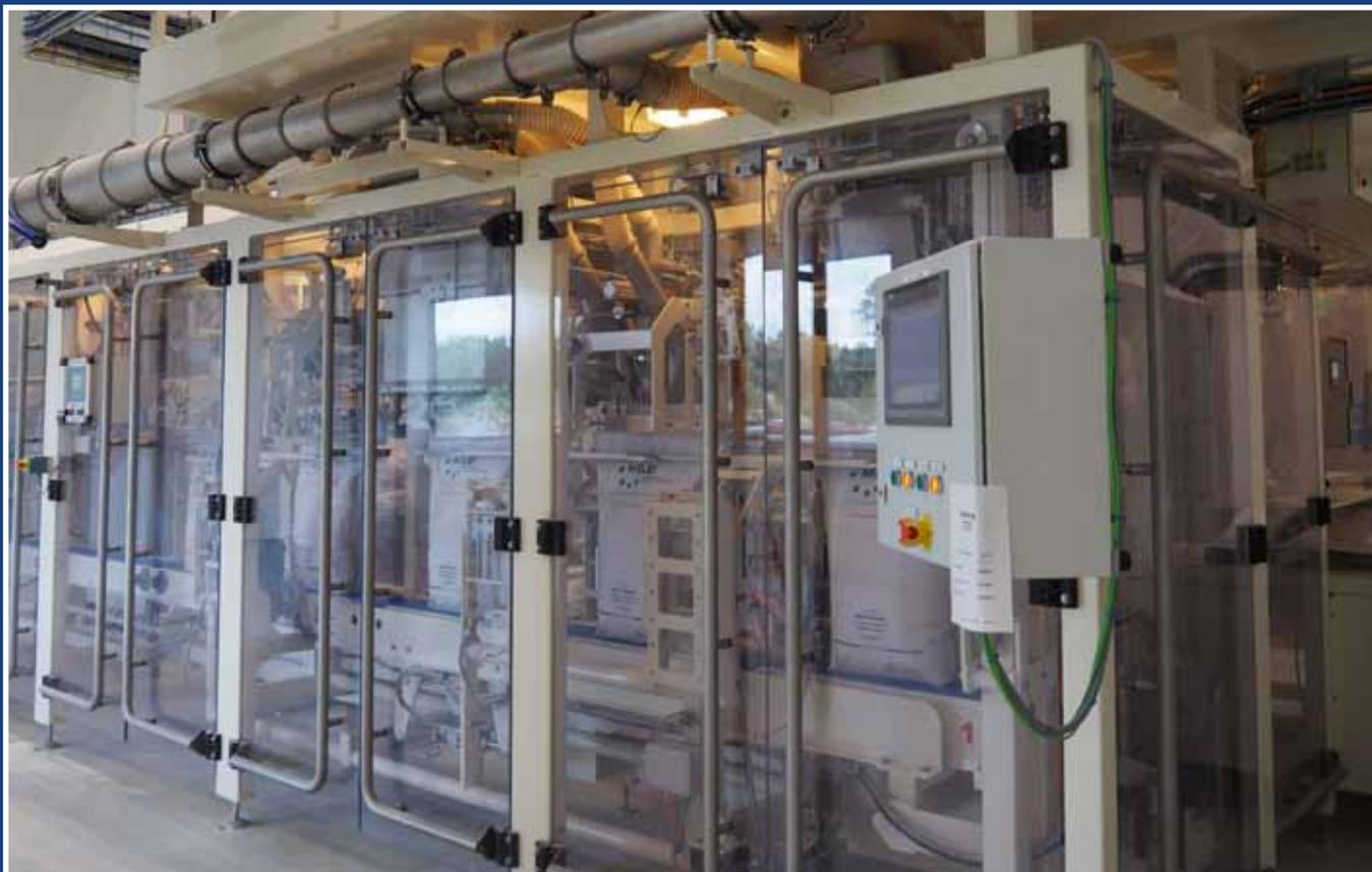
Installiert sind bei Milei zwei automatische Sackverpackungsanlagen von Arodo (Foto: mi)
