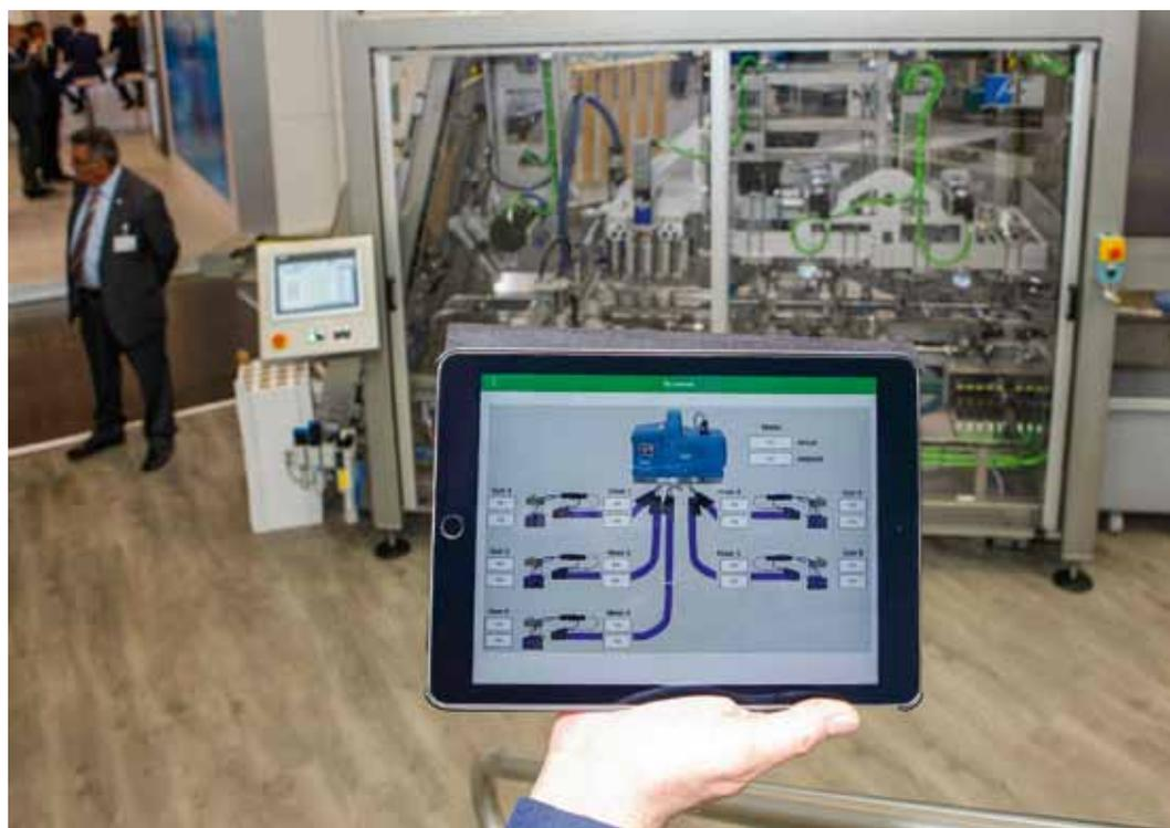
**Das Hotmelt-Auftragssystem ist auch von außerhalb der Verpackungsmaschine via Tablet-PC online kontrollier- und regelbar**
