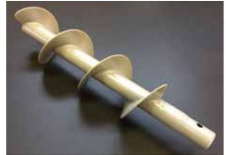
**Förderschnecke mit neuer widerstandsfähiger Anti-Haftbeschichtung im Dicksichtverfahren (0,3 mm) (Foto: Sulbana)**
