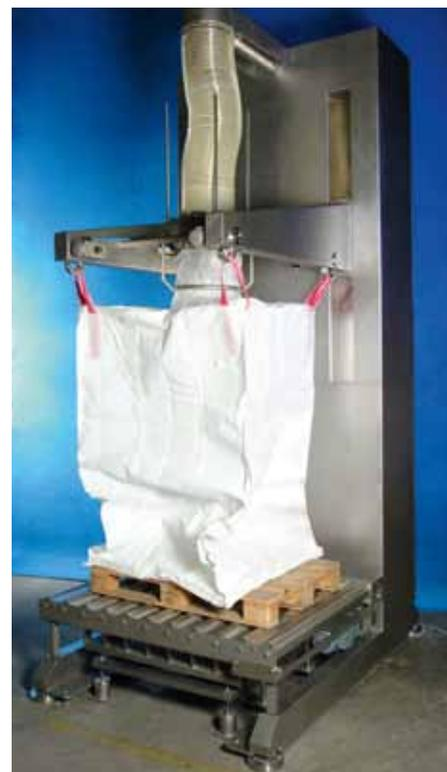
Die Big-Bag-Befüllstationen LFBS & LFBH sind mit einer eichfähigen, intelligenten Waage und einer Steuerung, bestehend aus Siemens Standardkomponenten, lieferbar (Foto: Derichs)
