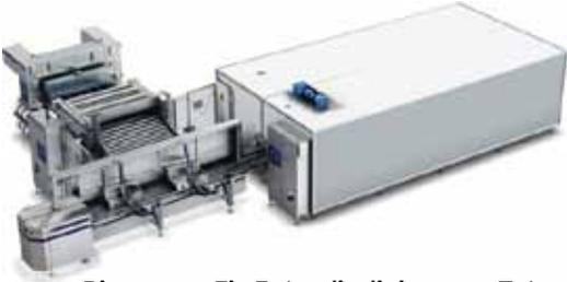
Die neue Eis-Extrudierlinie von Tetra Pak arbeitet mit einem unabhängig gesteuerten horizontalen Abscheider (Foto: Tetra Pak)
