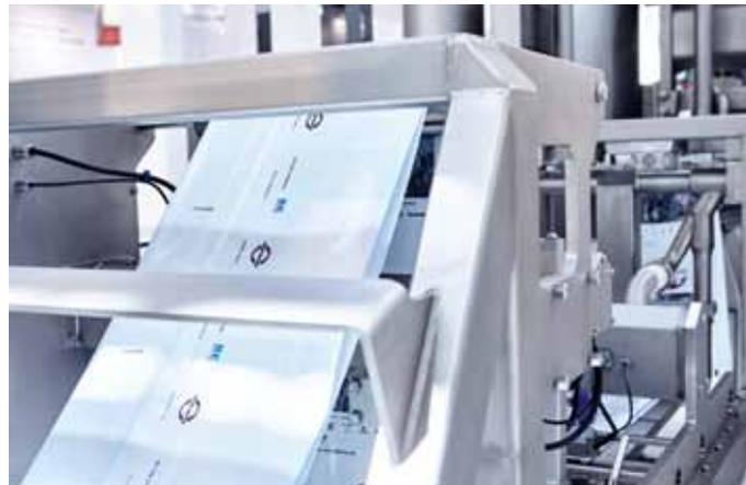
Die Säcke werden aus einem neuen PE-Folienmaterial namens FFS SepaFlex geformt. Entwickelt wurde das Verfahren von BEHN + BATES zusammen mit Bischof + Klein (Foto: BEHN + BATES)
