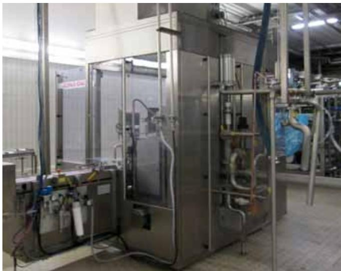
Butterstücke werden von einer Hochleistungsmaschine vom Typ IMA Benhil Ecopack FD140 geformt und verpackt (Foto: mi)
