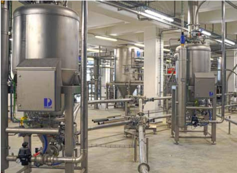
Die Dichtstromförderung wurde mit Druckfässern gelöst (Foto: Derichs)
