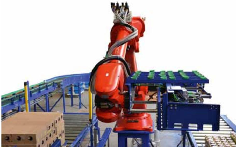
Der Palettierroboter ist mit einem Greifer ausgerüstet, der auf der einen Seite saugt und auf der anderen greift (Foto: de Man)
