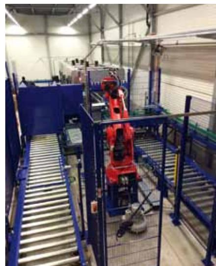
Parallel lassen sich bei Gropper Trays mit jeweils zehn Trinkbehältern eines Kaffeegetränks und Trays mit zehn Viererpackungen einer Puddingsorte palettieren (Foto: de Man)
