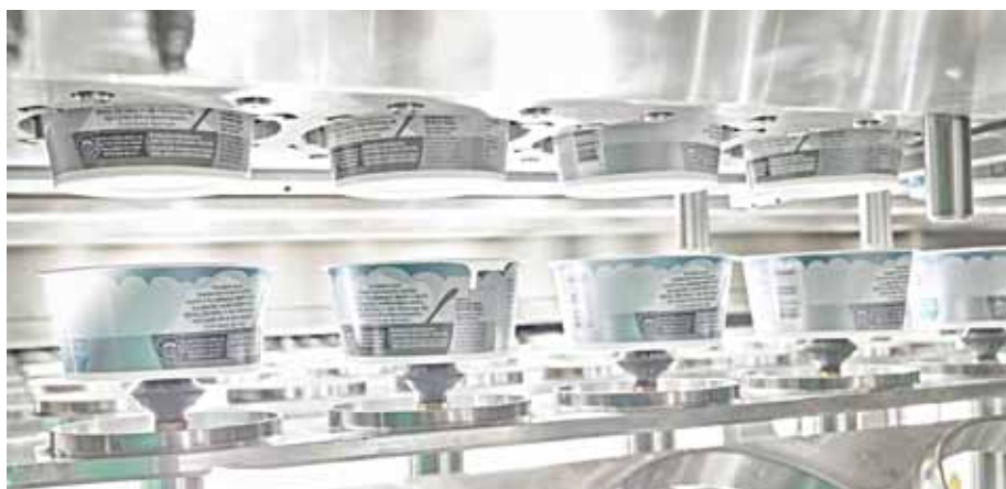
Garantierte Produktionssicherheit – „foreign body protection“: im Bereich der offenen Becher sind keine Kleinteile wie z. B. hängend montierte Schrauben vorhanden (Foto: GRUNWALD)
