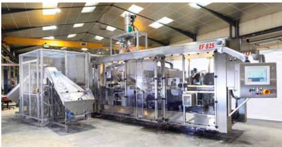
Ende Mai zeigte IMA Erca eine neue Lösung für die mexikanische Molkerei Lala, die pro Stunde 32.000 Top Cups auf einer EF825 Tiefziehmaschine produziert. Molkerei-industrie war vor Ort (Foto: IMA Erca)
