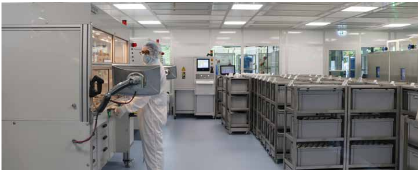
LifeTec Filter werden in einem Reinraum der Klasse 7 nach strengen hygienischen Standards gefertigt (Foto: Donaldson)
