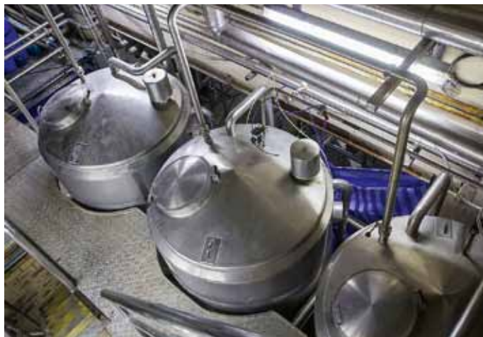
Valio hat seine Trockner mit Feuchtesensoren ausgestattet, um die Produktion von demineralisiertem Molkenpulver zu optimieren (Foto: Vaisala)
