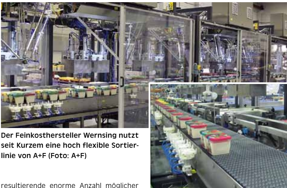
Blick auf das Sortierband, auf dem Pickroboter die gewünschten Produktsortierungen herstellen (Foto: A+F)
