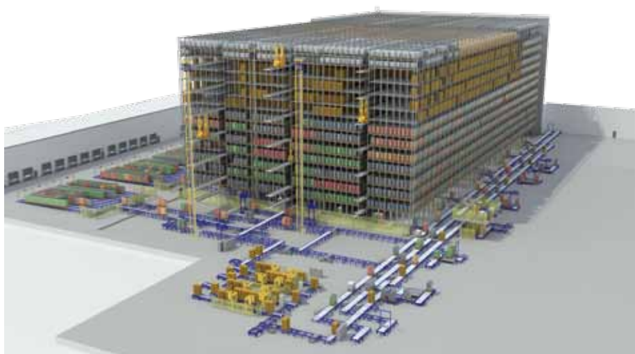
Das modulare Konzept der 3D-Matrix Solution steht für hoch-dynamische Systemlösungen zur Lagerung und Kommissionierung von Einzelartikeln, Kartons, Lagentrays und Paletten (Foto: SSI Schäfer)
