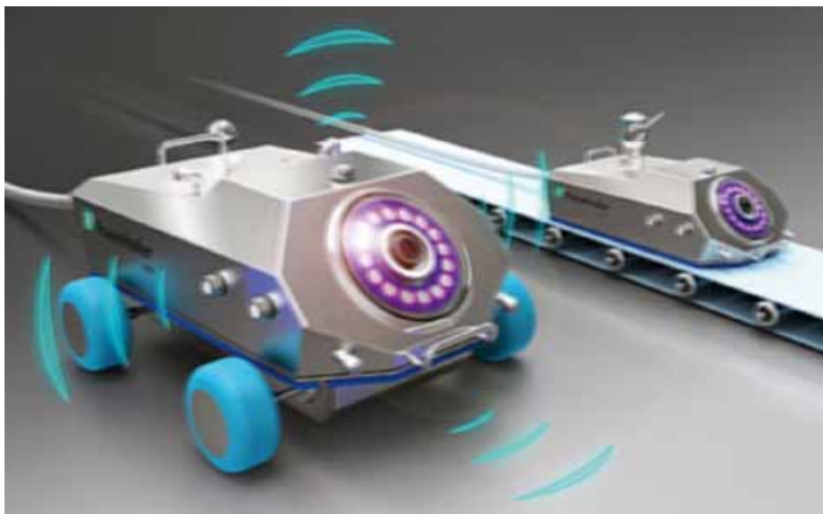
Fraunhofer IVV zeigt einen Reinigungsroboter mit optischem Sensorsystem zur Schmutzerkennung (Foto: Fraunhofer IVV)
