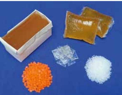
**Eine Leimoptimierung hat zwei Effekte: die Steigerung der Qualität sowie eine Senkung der Kosten. Um diese Ergebnisse zu erzielen werden die verwendete Klebetchnik und der Leim optimal aufeinander eingestellt (Foto: H + L Klebetchnik)**
