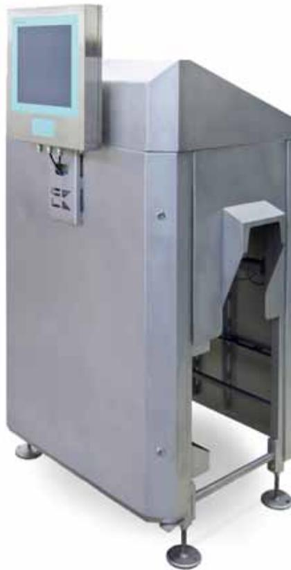
Der Vacu-Check erkennt fehlerhafte Verpackungen bei Käse (Foto: CLK)
