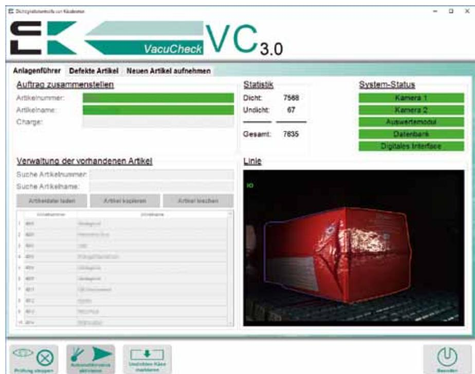
Der Vacu-Check kann an die Steuerung der Verpackungslinie angebunden werden. Auf diese Weise erfährt die Maschine direkt von Sortenwechseln (Abbildung: CLK)
