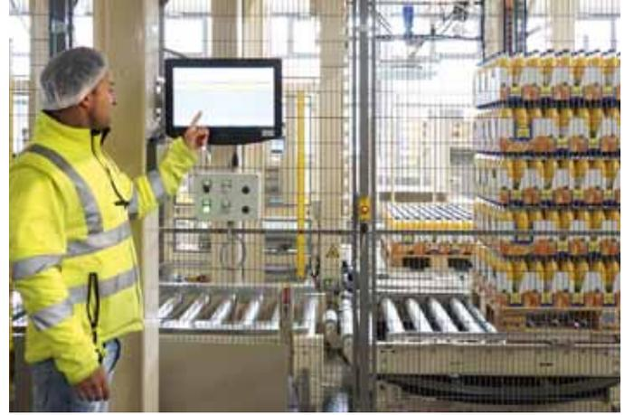
Mithilfe eines Barcode-Scanners erfassen die Gropper Mitarbeiter am CAITRON IPC die fertig beladenen Paletten in SAP
