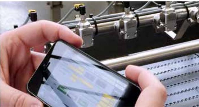
HIGH PERFORMANCE LUBRICATION (HPL), eine Kombination aus ULTRA DRY und der bewährten LOEHRKE Trockenbandschmierung, wurde für hohe Füllergeschwindigkeiten und schwierige Gebindeformen konzipiert. Eine benutzerfreundliche Steuerung per App erleichtert eine detaillierte Einstellung um das Bandschmiermittel nur dort aufzutragen, wo es benötigt wird. Das entschärft die Abwasserproblematik, schont die Umwelt und senkt die Betriebskosten. Ein weiteres Plus ist der Verzicht auf Frischwasser.
