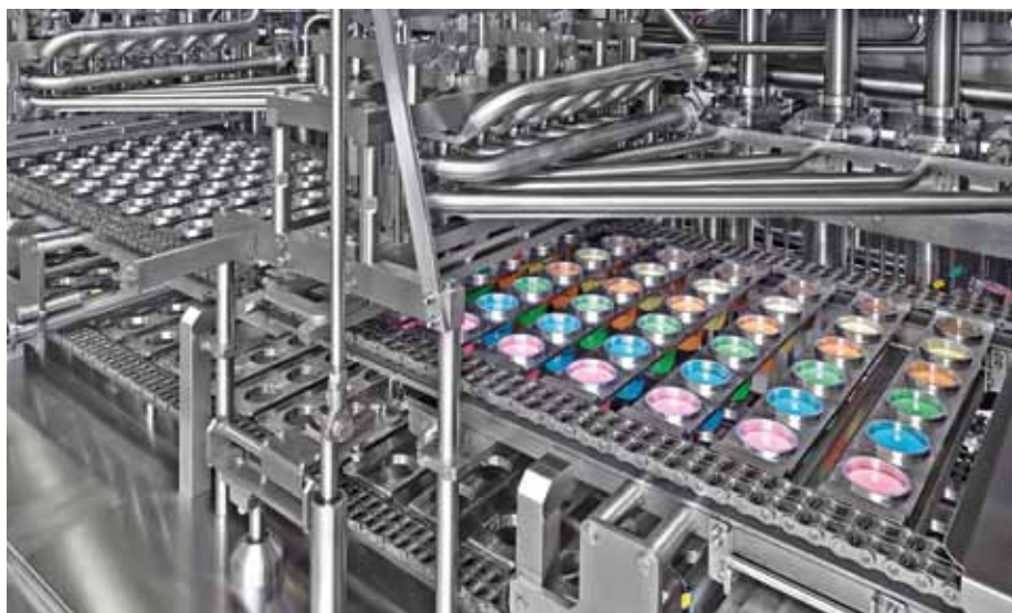
Abfüllanlage GRUNWALD-FOODLINER 6000 zur Abfüllung von Milchprodukten mit bis zu sechs verschiedenen Fruchtzubereitungen (Foto: GRUNWALD)
