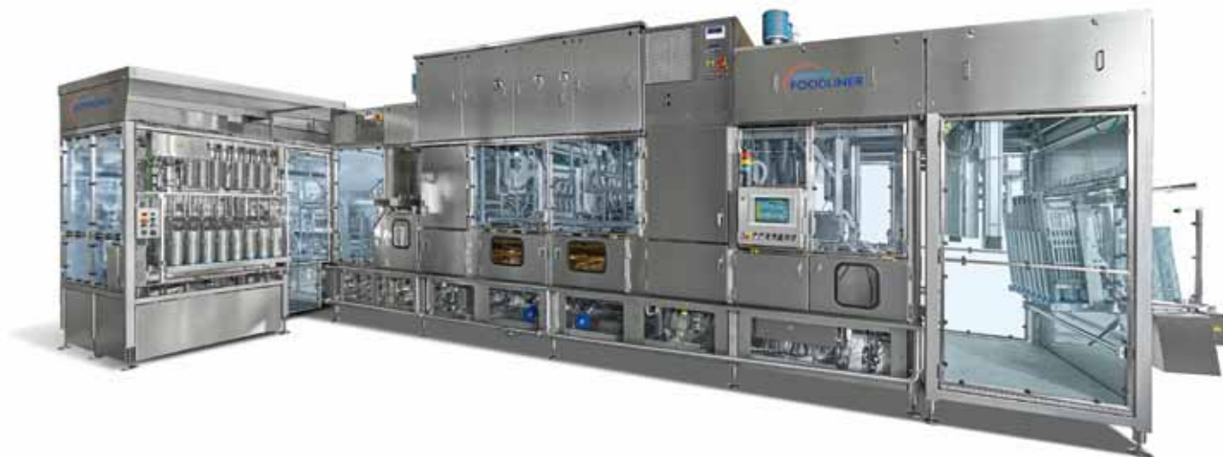
8-bahniger Längsläufer-Becherfüller GRUNWALD-FOODLINER 20.000 UC mit dem neuen und sicheren Hygienekonzept (Foto: GRUNWALD)
