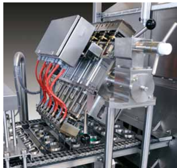
Drehbare Siegelstation mit zwei unterschiedlichen Siegelköpfen für einen schnellen Formatwechsel (Foto: GRUNWALD)
