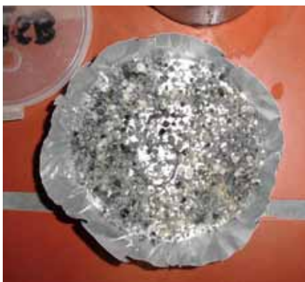
Abbildung 4: Durch im Abwasser enthaltene Reinigungsmittel geschädigter Pelletschlamm
