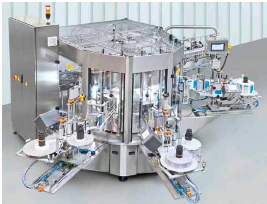
Rundläufer-Etikettiermaschine GERNEP Soluta für flexible Selbstklebe-Etikettierung (Foto: GERNEP)
