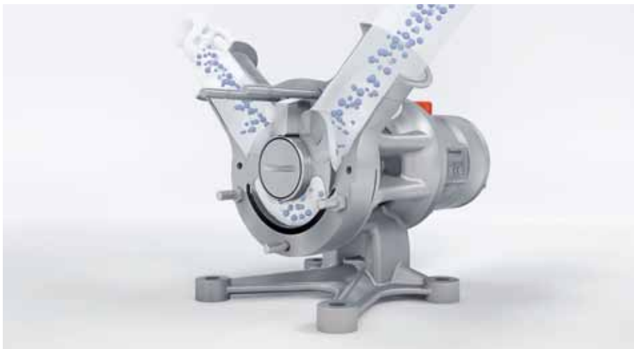
Bei Sinuspumpen wird das Medium in 4 umlaufende Kammern verschoben. Das Kammervolumen ändert sich während des Pumpvorganges nicht (Foto: WMFTG)
