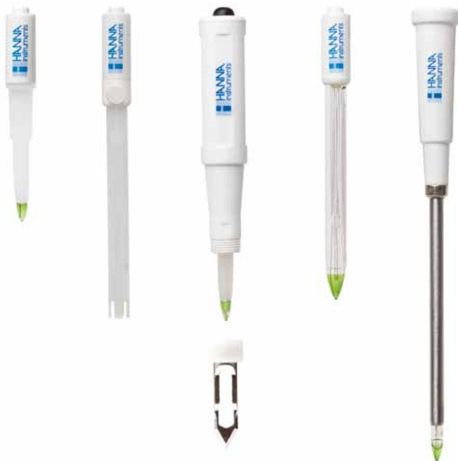
Die fünf Foodcare Spezial Elektroden für die HI9816X pH-Meter. Von links nach rechts, die Modelle für allgemeine Anwendungen in der Lebensmittelanalytik, für Milch, für Fleisch (mit auswechselbarer Edelstahlklinge), für Joghurt und für Käse (Foto: Hanna Instruments)
