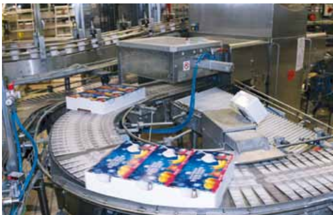
Durchleuchtete Mila-Produkte verlassen den OCS-Scanner (Foto: OCS Checkweighers)
