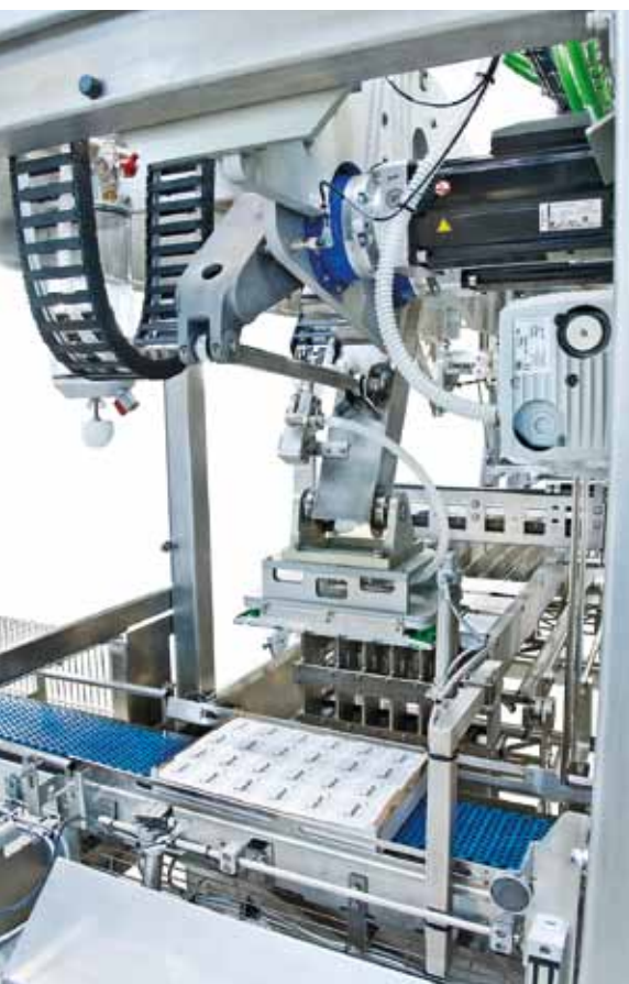
Detaillansicht des Top-Loaders 2100 i von Sema (Foto: Sema Systemtechnik)
