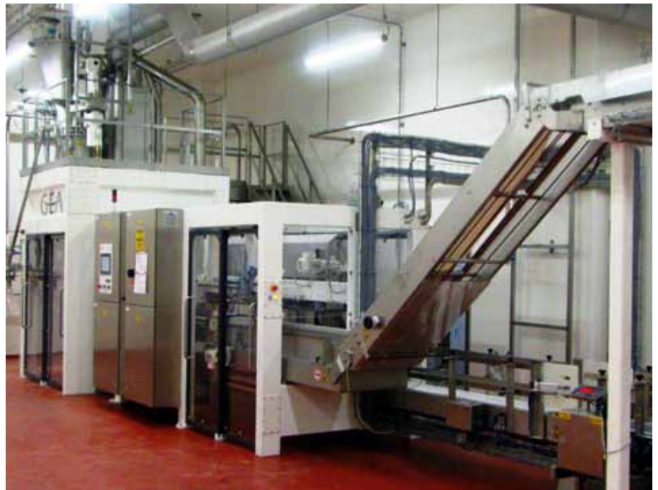
Die Absackung der Dry Mix Lactose liegt in der strengsten Hygienezone im gesamten Molke V Trakt (Foto: UTM)
