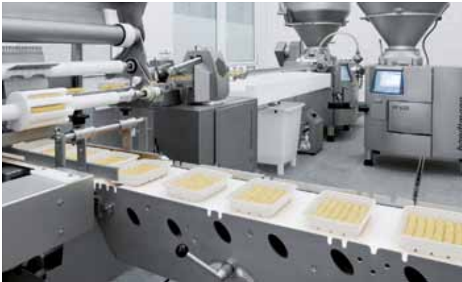
Konventionelles ConPro-System zur Herstellung geschnittener Molkereiprodukte in Alginathülle. Im Bild mit nachgeschaltetem Gruppiermodul
