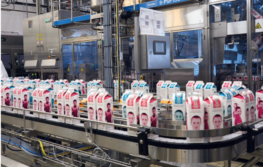
Die zweibahnige S-PSF130UC kann zwei verschiedene Produkte zugleich abfüllen (Foto: mi)
