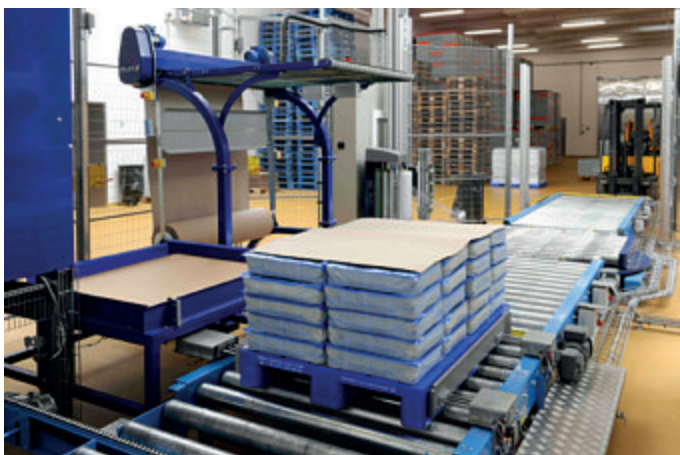
Antim Anti-Rutschpapier wird für einen stabilen Palettenaufbau ganz unten und dann auch weiter oben platziert (Foto: PAL-Cut)
