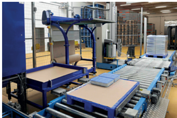
PAL-Cut ist in die Palettierungsanlage integriert; es wird immer nur ein einzelner Bogen abgegeben. So besteht nur ein minimales Risiko, dass der Packroboter Bögen verliert (Foto: PAL-Cut)
