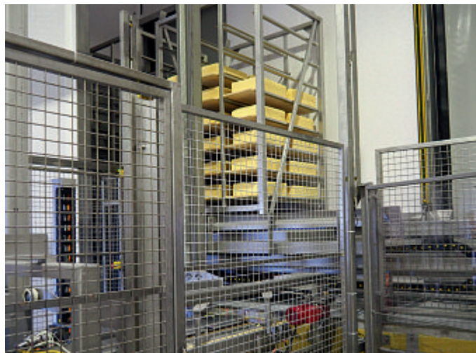
Die Käse werden über einen Packroboter aus bzw. in die Gestelle gesetzt, hier erfolgt auch das Ent- bzw. Verheiraten mit den Reifungsbrettern (Foto: mi)
