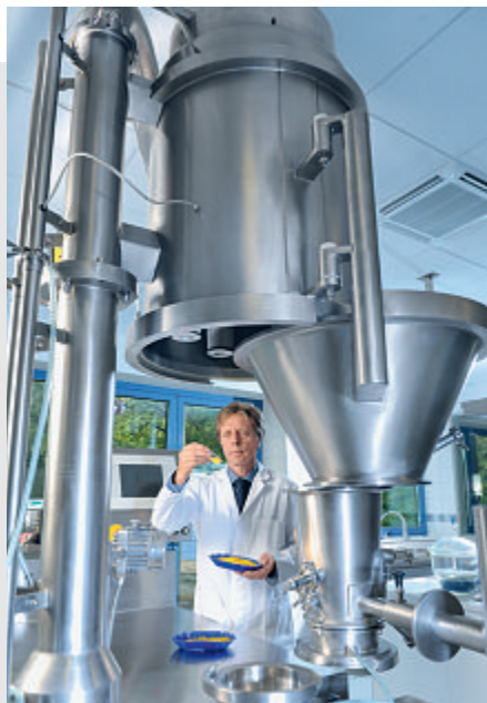
SternMaid verfügt auch über eine multifunktionale Wirbelschichtanlage (Foto: SternMaid)
