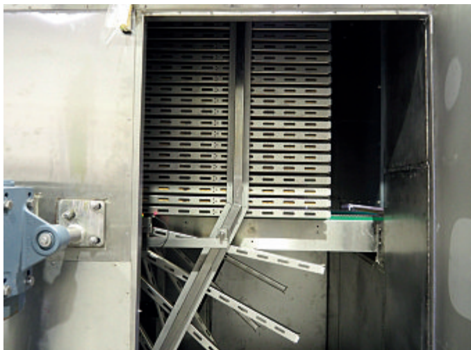
Blick in den Paternoster, in dem die Käseblocke entkeimt und temperiert/befeuchtet werden (Foto: mi)
