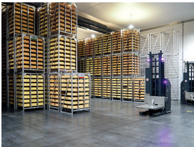
Blick ins Reifungslager – alle Transportvorgänge laufen automatisch über fahrerlose Fahrzeuge ab (Foto: mi)
