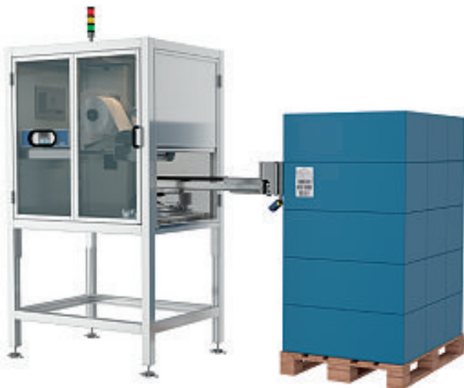
Etikettendruckspender M230i zur Palettenkennzeichnung (Abb.: Domino)
