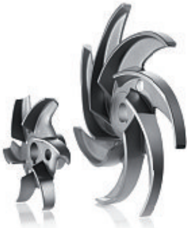
Offene Laufräder in Verbindung mit strömungstechnisch optimierten Fließkanälen ermöglichen die sehr schonende Förderung auch bei hohen Volumenströmen
