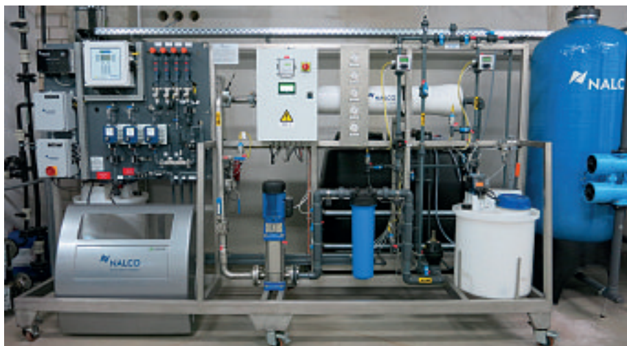
Mit der 3D TRASAR Technologie werden bei jedem Reinigungsvorgang Parameter wie Wasserverbrauch, Temperatur, Zeit, Konzentration usw. aufgezeichnet
