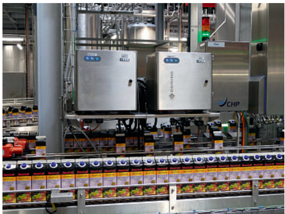
Jede Elopak Anlage hat eine Ausbringungslleistung von 12.000 Verpackungen pro Stunde und verfügt über zwei Transportbänder, an denen jeweils ein Drucksystem benötigt wird (Foto: Domino)
