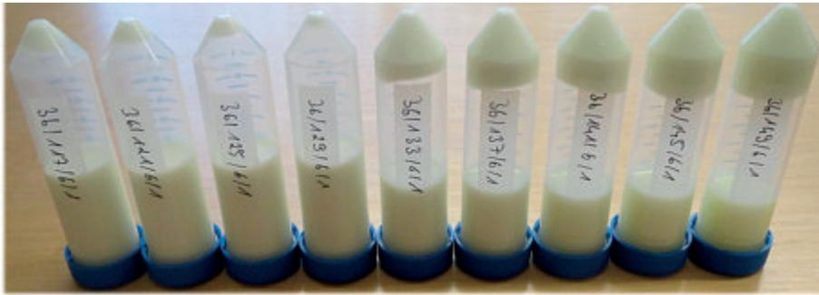
Abbildung 2. Zentrifugenröhrchen mit Magermilchkonzentrat mit 27 % Trockenmasse nach der direkten Erhitzung und Zentrifugation bei 4000g für 10 min. Von links nach rechts wurde die Erhitzungstemperatur im Bereich von 117 bis 149 °C variiert
