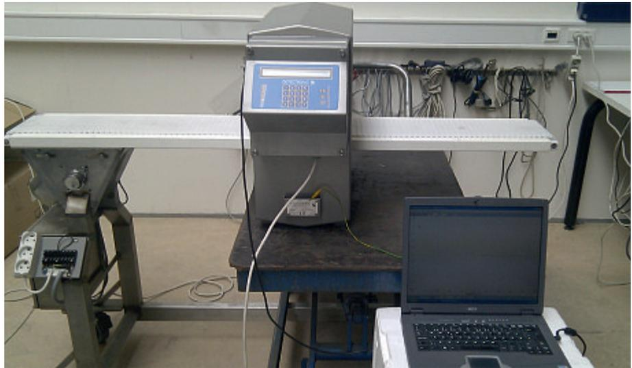
**Abbildung 2a:** Der Metalldetektor von Detectronic (Modell-Nr. 606-250), mit dem die Erkennbarkeit von metalldetektierbaren Kunststoffen überprüft wurde, die in der Herstellung von Arbeits- und Reinigungsgeräten für die Lebensmittelindustrie verwendet werden
