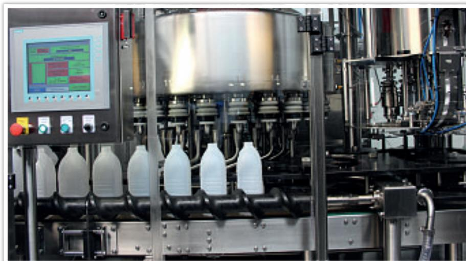
**TREPKO 3000 Hochleistungs-Rundfüller in UC-Ausführung mit Flaschenspül-, Füll- und Verschlussstationen (Foto: mi)**
