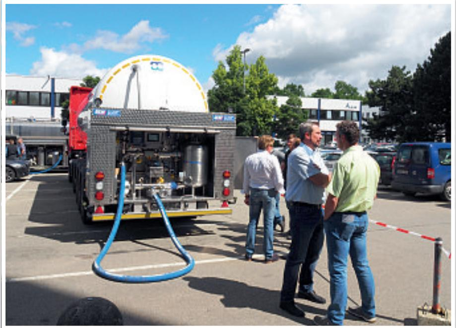
**HLW hat eine Milchannahme für den TSW entwickelt, die nur über Akku betrieben wird. Live wurden auf der die OPTITool-Tagung begleitenden TSW-Vorführung mehrere Tausend Liter Wasser umgepumpt (Foto: mi)**
