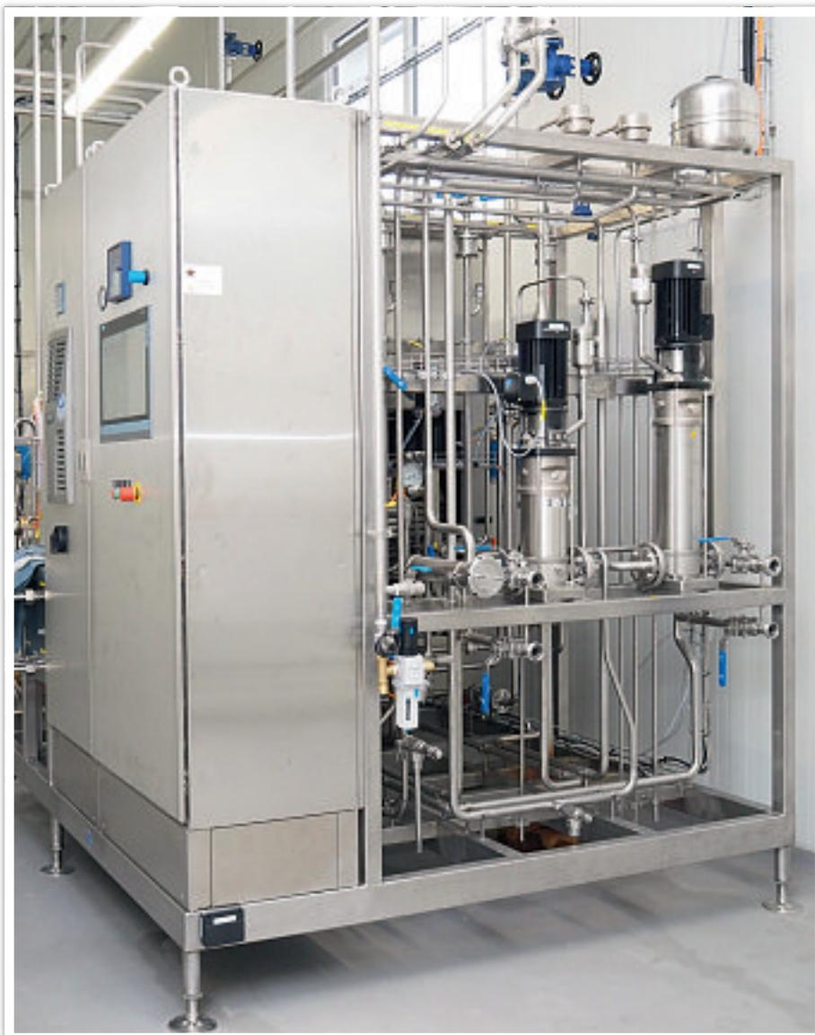
Die von Asepto mitsamt Peripherie gelieferte UHT-Linie hat eine Leistung von ca. 1.000 l/h (Foto: mi)
