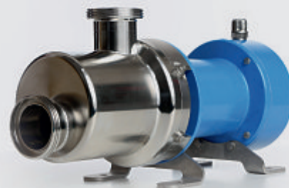
Der Deckel und das Pumpengehäuse der Schraubenspindelpumpe SLH-4U sind zu einem Teil zusammengeführt (Foto: ITT Bornemann)
