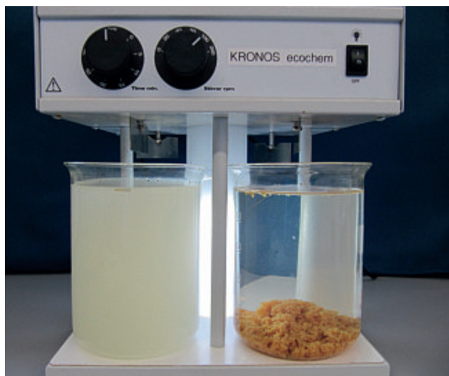
Das Bild zeigt Molkereiabwasser vor und nach der Applikation der Chemikalien. Die entsprechenden Reaktionen finden auch in Großanlagen in wenigen Sekunden statt. Die braunen Flocken enthalten den Schmutz aus dem Abwasser und werden in den Großanlagen abgetrennt, sodass der sogenannte Klarlauf entsteht (Foto: Dr. Kramer)
