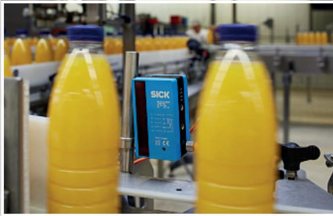
**Nicht nur in der Füllstandmessung sichern SICK-Sensoren den Verpackungsprozess: Der WTB12-3P2431 erkennt das Stauverhalten der PET-Flaschen (Foto: SICK)**
