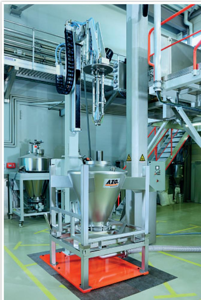
Der zu reinigende Container wird auf die Station aufgesetzt oder automatisch herantransportiert. Zentrierecken erleichtern die Positionierung. Mit einer patentierten Andockmanschette wird eine staubdichte Verbindung zwischen Containerauslauf und Absaugtrichter hergestellt. An diesen Trichter ist eine Absaugung über eine Zentralfilterstation angeschlossen. Die Auslaufklappe des Containers kann von Hand oder automatisch betätigt werden.
