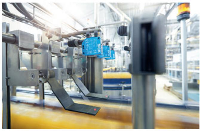
Nicht nur in der Füllstandmessung sichern SICK-Sensoren den Verpackungsprozess: Der WTB12-3P2431 erkennt das Stauverhalten der PET-Flaschen (Foto: SICK)
