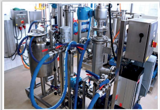
Mit der MF-Pilotanlage im Technikum der Universität Hohenheim wird an der Konzentrationsfermentation von Frischkäse geforscht
