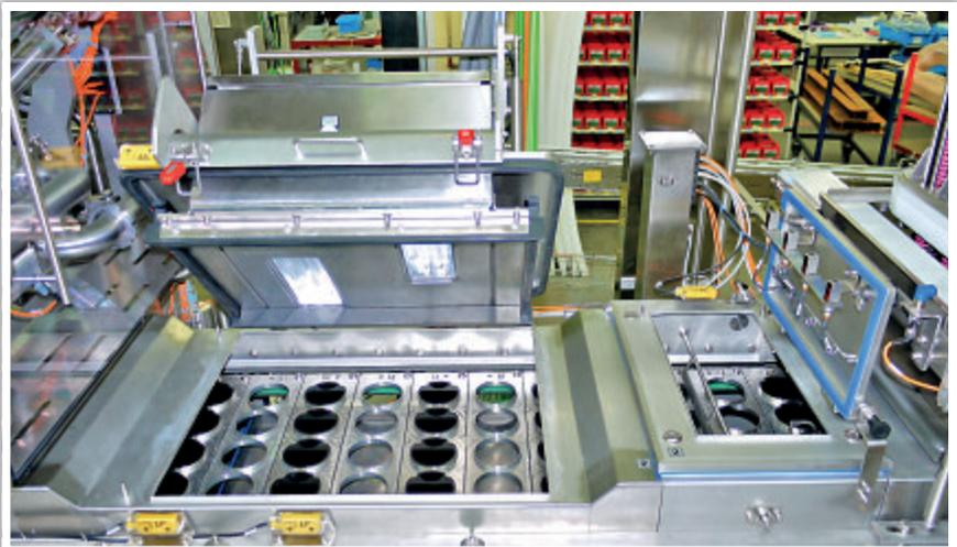
Hochleistungs-Becher-Füll- und Verschleißmaschine, Typ DOSOMAT 20 mit „Pulsed Light“ Becherentkeimung, UVC-Bestrahlung der Siegelplatinen, sowie integrierter Endverpackung (Foto: WALDNER)
