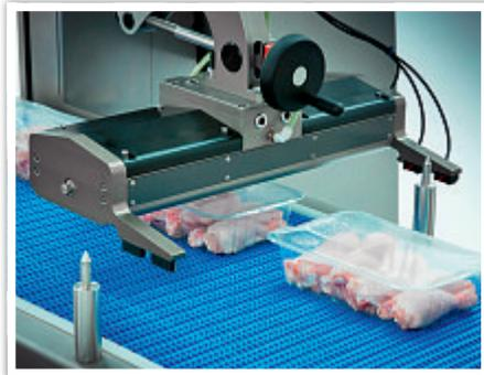
Das neu entwickelte System Ishida Air-Scan findet mit Lasertechnologie sogar kleinste Löcher in MAP-Verpackungen (Foto: Ishida)
