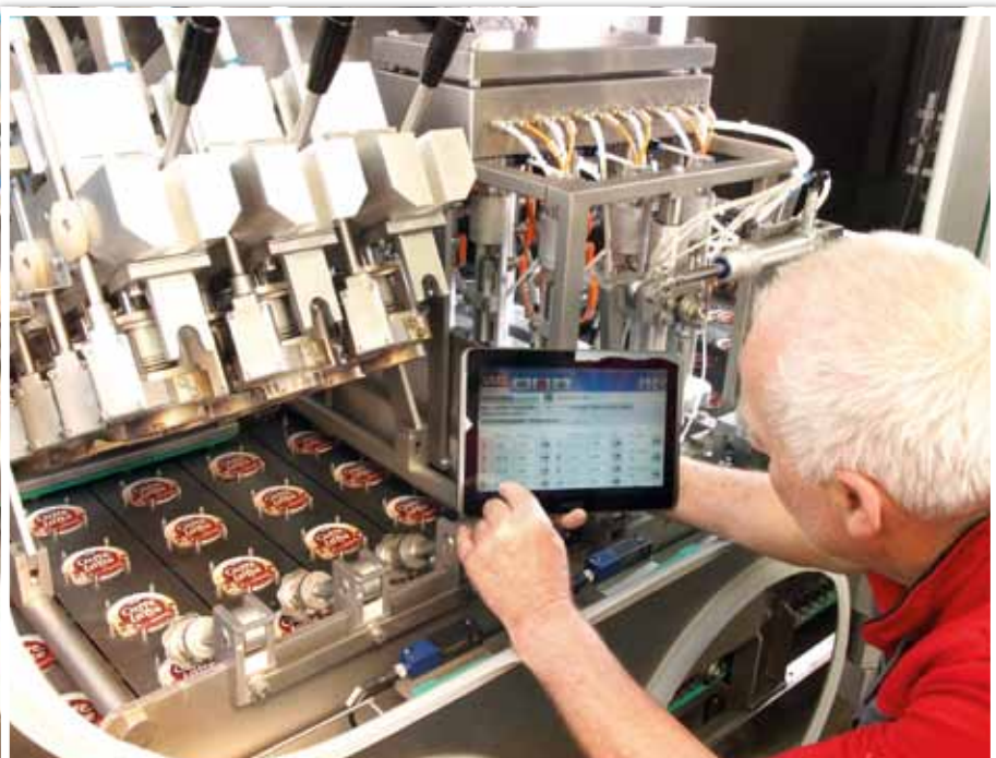
VMS-Servicetechniker bei der Einstellung/Überprüfung der Temperaturen der Siegelköpfe am alten Standort in Engelhofen (Foto: VMS)
