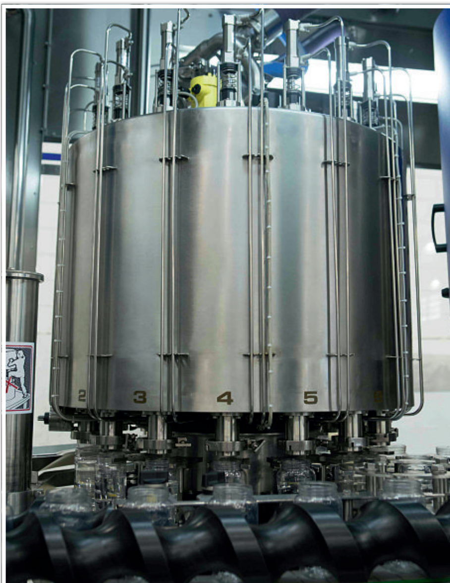
Die gravimetrische Abfüllung wird bei hochviskosen Produkten durch Überdruck unterstützt (Foto: Serac)
