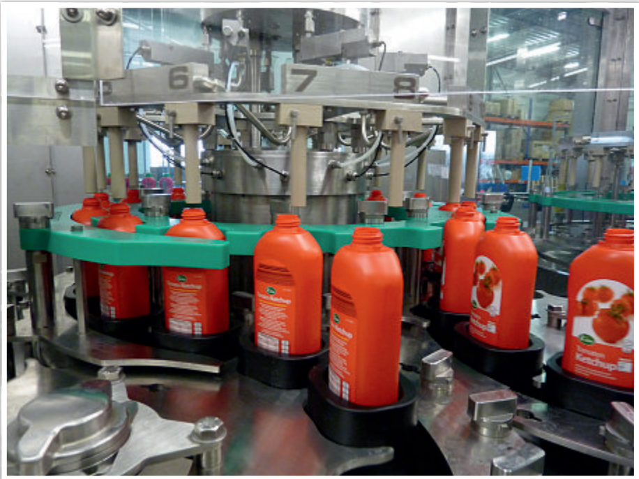
Chemische Dekontamination der Verpackung direkt vor gravimetrischen Abfüllung (Foto: Serac)
