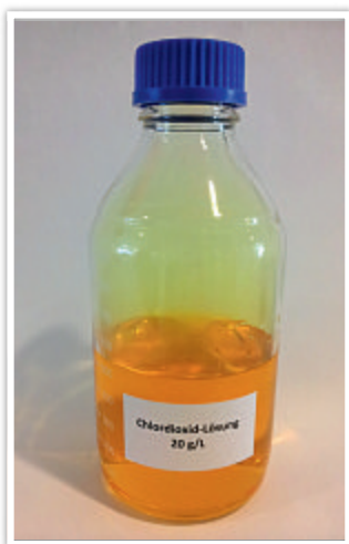
Abbildung 2: Chlordioxidgas im Gleichgewicht über einer Chlordioxidlösung
