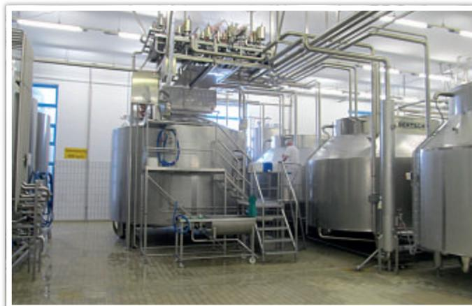
Der 24.000-l-Fertiger von Kalt Maschinenbau AG wird in Landquart für Großblockkäse genutzt (Foto: mi)
