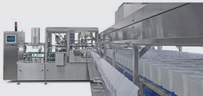
GRUNWALD-Becherfüll-Linie für UF-WHITE CHEESE, eine neu entwickelte Abfüll-, Koagulations- und Verschleißanlage für die Herstellung verschiedener Arten von Weichkäse zur Abfüllung in vorgefertigte Kunststoffbecher (Foto: GRUNWALD)
