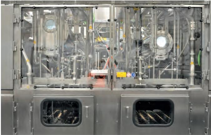
Fülldüsen werden in eingebautem Zustand mit gereinigt (Foto: GRUNWALD)
