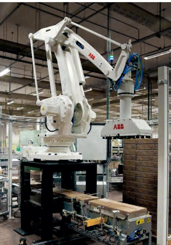
Um seinem Kunden schon vor der Installation die Funktionsweise der fertigen Zelle zu demonstrieren, simulierte ABB mit ihrer Software RobotStudio die komplette Lösung einschließlich der Zykluszeiten der Robotertätigkeiten. So können Automationslösungen schnell in den laufenden Betrieb integriert werden.
