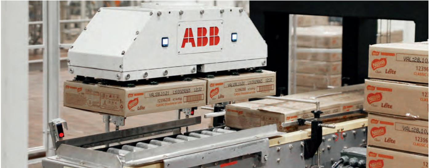
Der IRB 660 mit seiner Handhabungskapazität von 180 bzw. 250 kg ist für die Aufgabenbereiche Palettierung und Materialhandling perfekt geeignet.
