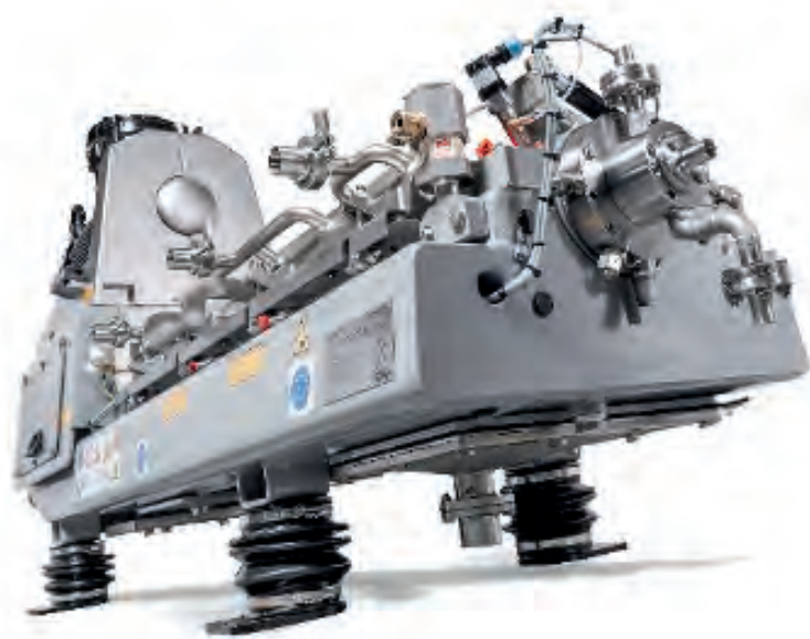
Dekanter zur Extraktion der unlöslichen Feststoffe
