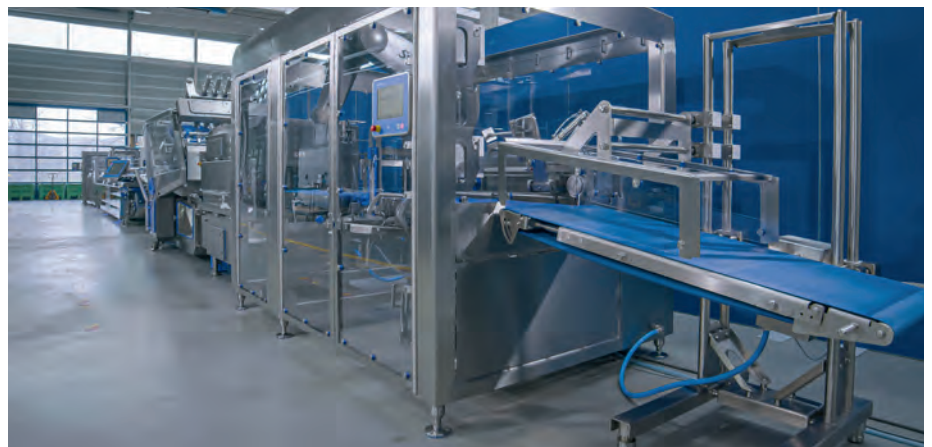
Der neue Käseblockteiler weDIVIDE teilt Blöcke in egalisierte Riegel, die den gewünschten Scheibenformaten entsprechen (Foto: Weber Maschinenbau)
