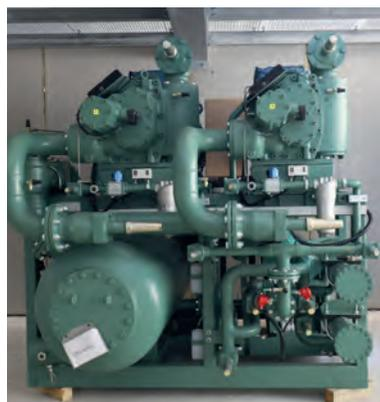
Für den Endausbau ist geplant: Kaltsöle to/tc -15 °C/ +36 °C, Qo 2x 1725 kW, Qw 2x 484 kW, Eiswasser to/tc -0,5 °C, Qo 3053 kW, Qw 533 k.
