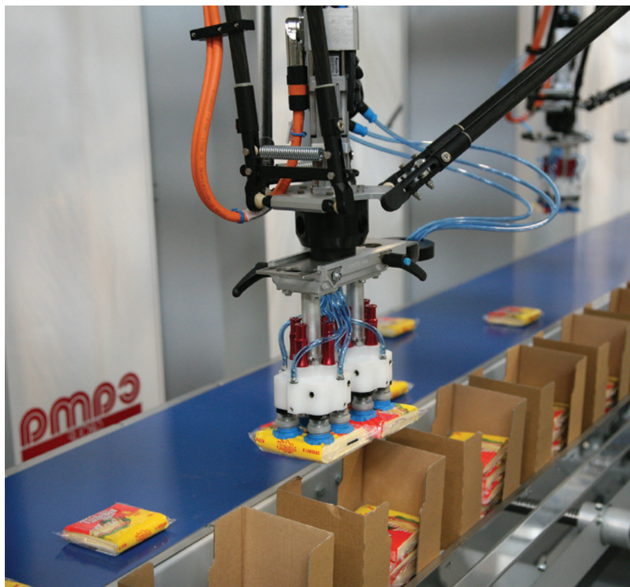
Verpackungslinie der CAMA Group mit Greifern aus piGRIP-Saugnapfen und COAX-Vakuumgeneratoren (Foto: Piab)
