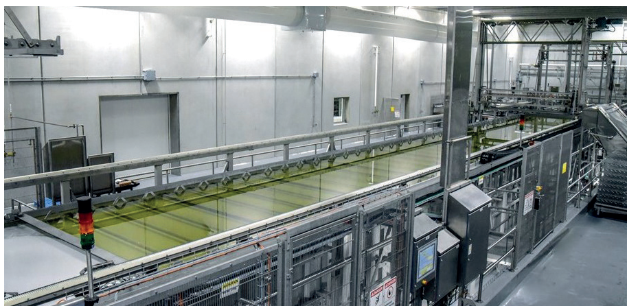
Die Bewegung der Wannen oder Regalen bei kranlosen Systemen übernehmen aus Chromstahl gefertigte Servomanipulatoren (Foto: ALPMA Sulbana)
