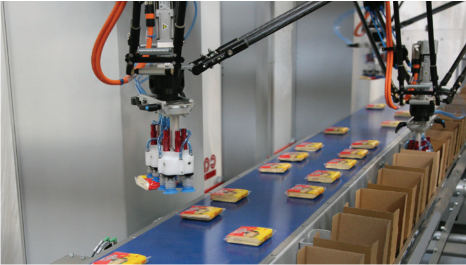
Das Verpacken von kleinen Beuteln in Kartons ist die Spezialität der piGRIP-Saugnapfe (Foto: Piab)
