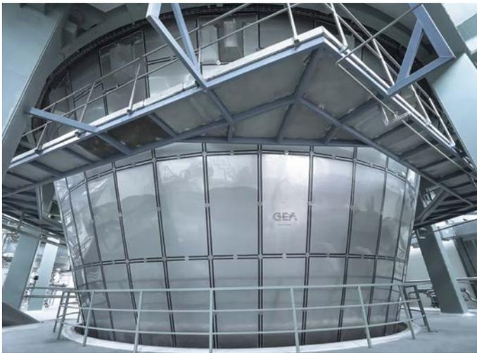
**Die MSD Sprühtrockneranlage ist mit hygienischen Isolierpaneelen aus nichtrostendem Stahl ausgerüstet, welche mit zwei isolierenden Luftschichten für eine hervorragende Wärmedämmung sorgen und jederzeit leicht demontierbar sind, um die Kammerwand auf feine Risse prüfen zu können. (Bild: GEA)**
