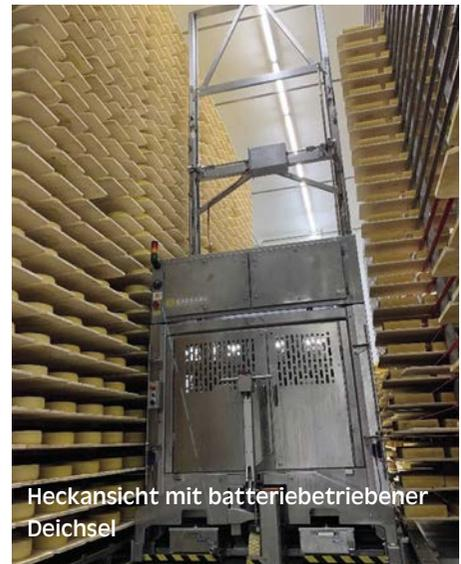
Heckansicht mit batteriebetriebener Deichsel
