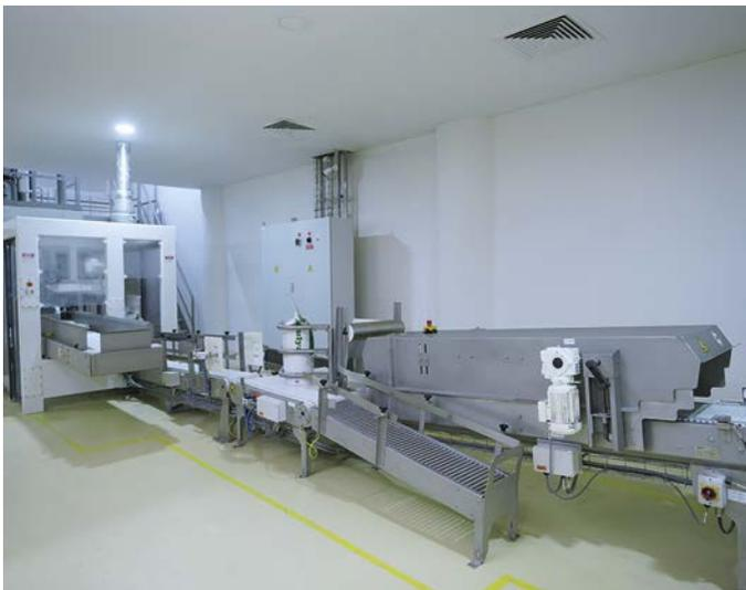
Die vollautomatische Hochgeschwindigkeits-Verpackungslinie aus der größten GEA Baureihe für 25-kg-Pulversäcke bietet einen vollständig überwachten Abfüllvorgang in einem geschlossenen Füllbereich. (Bild: GEA)
