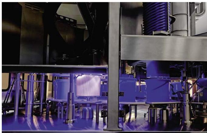
**Blick auf die UV(C)-Entkeimung eines Rundläufer-Eimerfüllers GRUNWALD-ROTARY XXL (Foto: Grunwald)**
