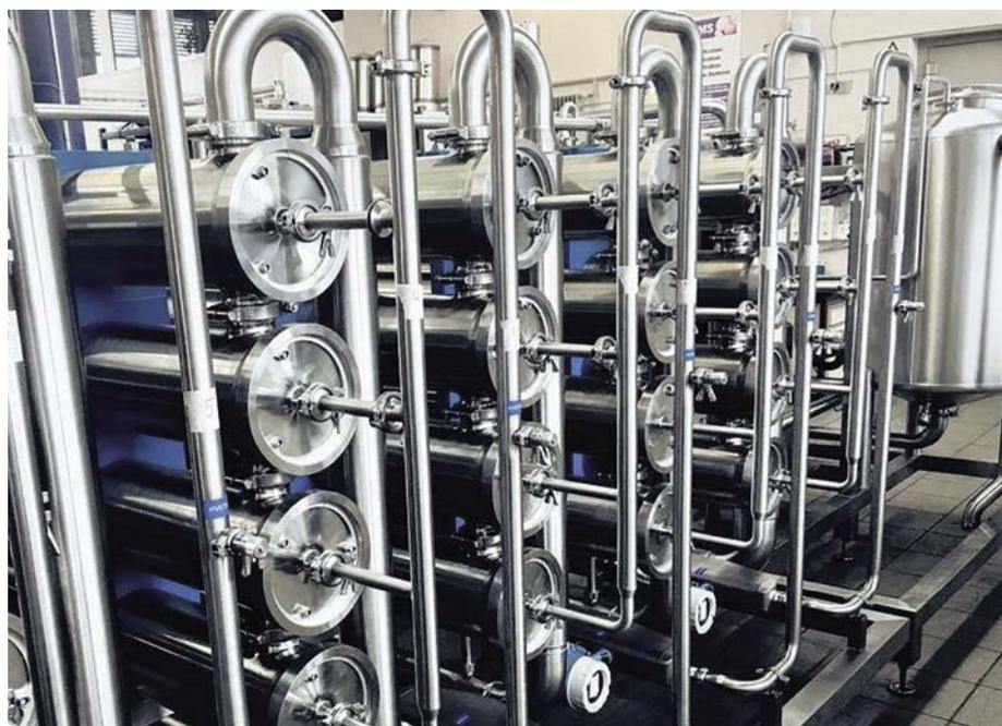
Abbildung 1: Heißwasser sanitisierbare UO Anlage (Foto: MMS AG Urdorf Schweiz)
