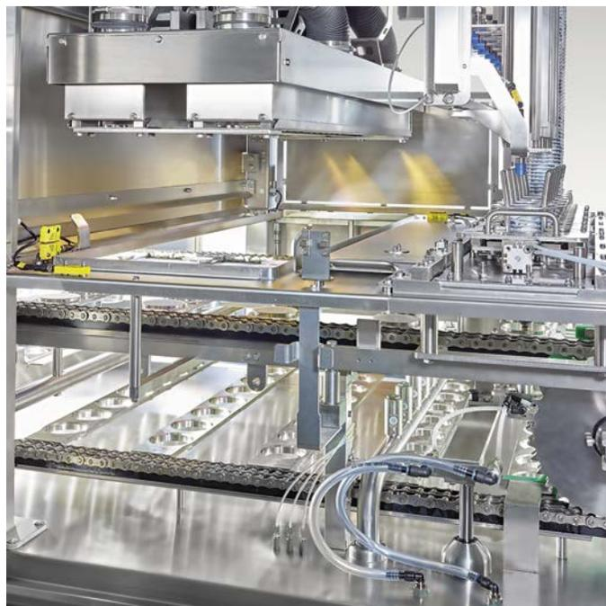
**Zweifach Pulsed-Light-Hochleistungs-UV(C)-Becherentkeimung mit einer garantierten Entkeimungsrate von mind. LOG 4 (Foto: Grunwald)**
