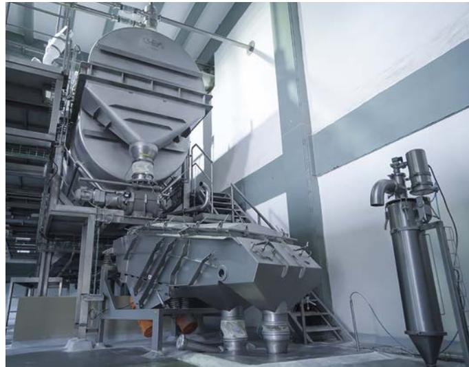
Im GEA Scan-Vibro Vibrationsieb erfolgt die hochhygienische Sicherheitssiebung des fertigen Pulvers. (Bild: GEA)
