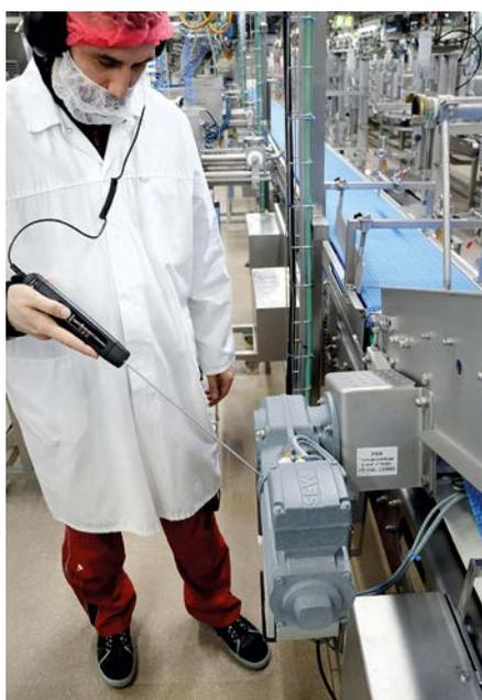
Die zahlreichen Antriebe der Förderanlagen prüft ein Servicetechniker stichprobenartig – sie lassen sich notfalls ohne große Auswirkungen auf die Produktion austauschen. (Foto: SEW)
