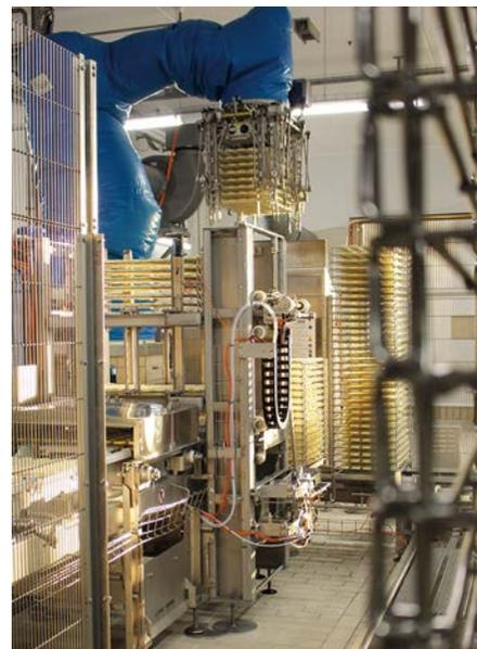
Die Umhörung wird in der hochautomatisierten Käserei von Robotern erledigt
