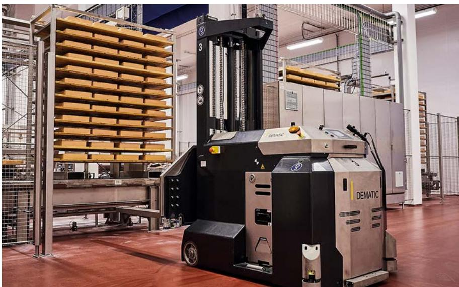
**Dematic hat bei der Vorarlberg Milch eGen ein maßgeschneidertes Fahrerloses Transportsystem (FTS) installiert. Vier Fahrerlose Transportfahrzeuge (FTF) übernehmen dort alle Transportbewegungen zwischen Reiferäumen und Pflegeanlage und werden dabei von der integrierten Dematic-Navigationssoftware manövriert (Foto: Vorarlberg Milch)**
