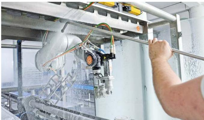
**Der Staubli TX2-90 he ist HACCP-zertifiziert und darf bei Verwendung von H1-Öl im direkten Lebensmittelkontakt ohne zusätzlichen Schutzanzug arbeiten.**
