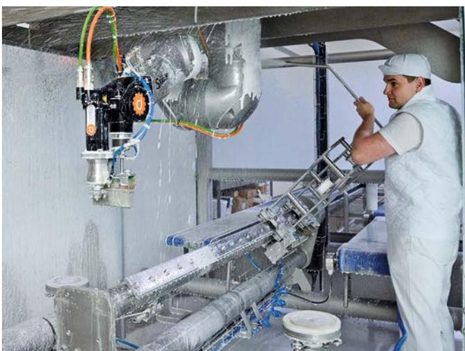
**Der Roboter wird von innen mit bis zu 50 mbar Druck beaufschlagt, sodass von außen kein Reinigungsmittel eindringen kann. Er verträgt das Abstrahlen mit heißem Wasser, das Einschäumen mit Reinigungskemikalien und manuelles Bürsten.**
