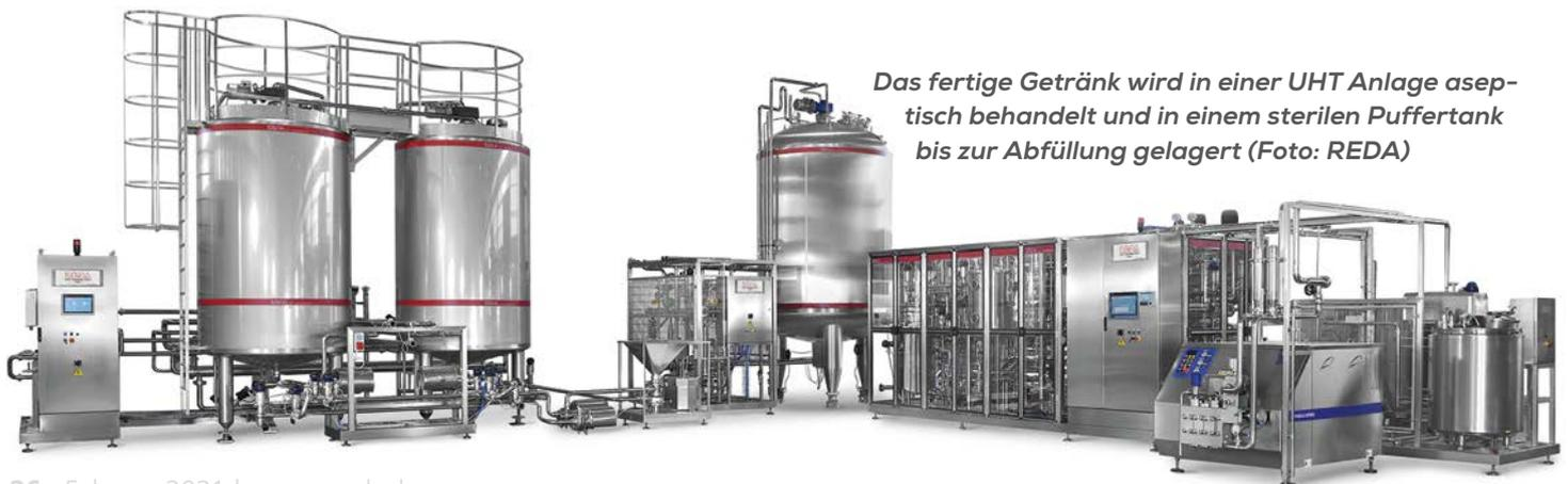
*Das fertige Getränk wird in einer UHT Anlage aseptisch behandelt und in einem sterilen Puffertank bis zur Abfüllung gelagert (Foto: REDA)*
