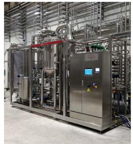
Die Pasteurisierung ist mit einem Entgaser ausgestattet (Foto: REDA)
