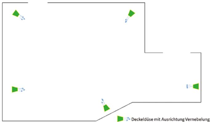
Abb. 2: Positionen und Ausrichtung der Deckeldüsen bei der Stoßentkeimung in der Abfüllung (Prinzipische Skizze)
