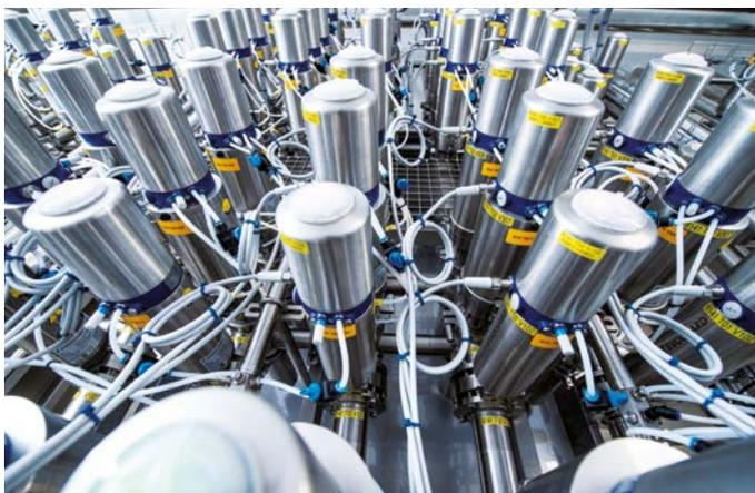
**Ein Ventilknoten von Evoguard steuert, auf welchem der fünf Karton-, Großcontainer- und Bag-in-Box-Füller Milch, Sahne und Saft abgefüllt werden.**
