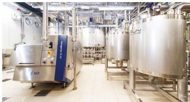
Der Homogenisator von HST wird zur Teil-Homogenisierung der Trinkmilch eingesetzt (Foto: Krones)
