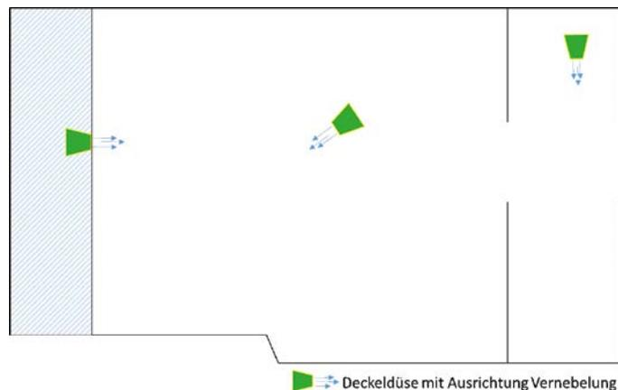
Abb. 3: Positionen und Ausrichtung der Deckeldüsen bei der Stoßentkeimung in der Laktosedosierung (Prinzipische Skizze)
