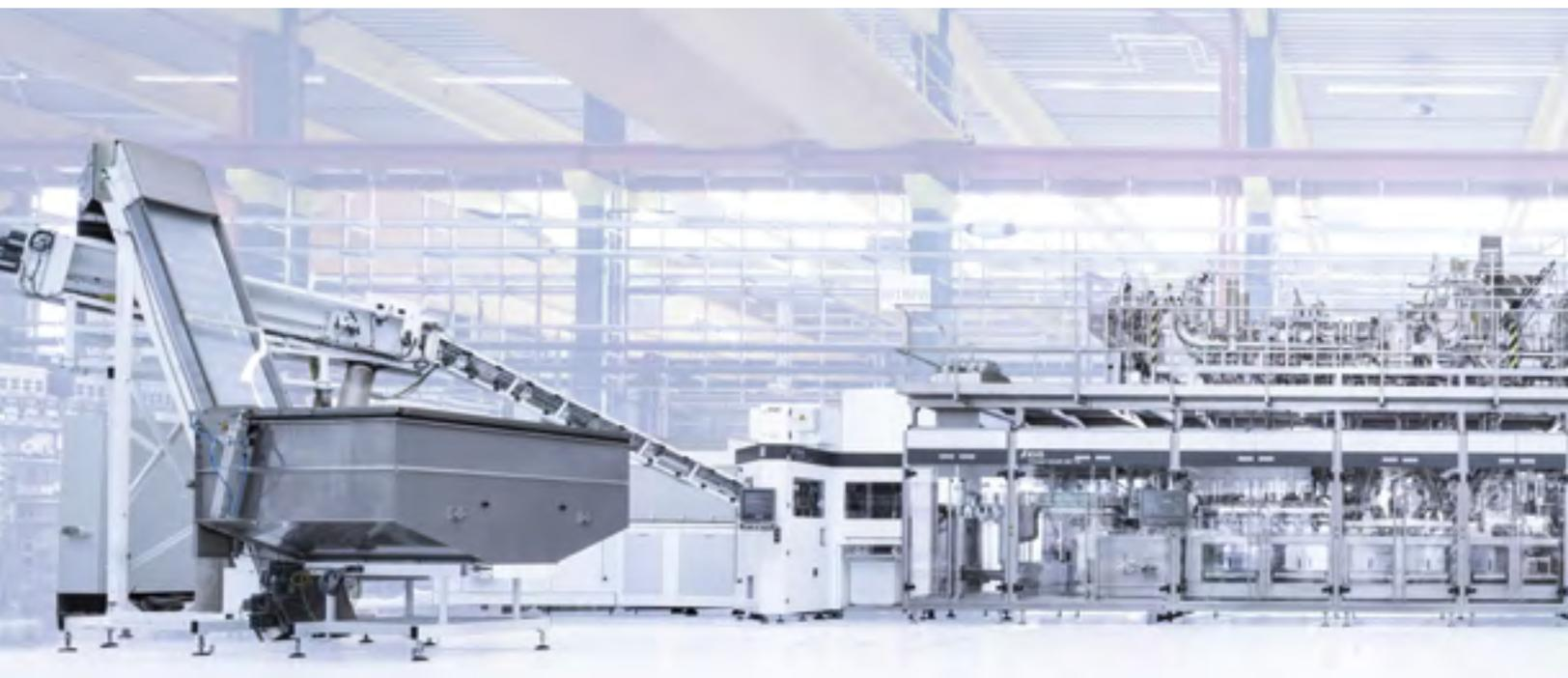
Der Linearfüller Innosept Asbofill ABF 712 für sensitive Produkte ist sowohl im Aseptik- als auch ESL-Standard erhältlich. Die Sterilisation erfolgt im KHS-Verfahren mit einem Wasserstoffperoxid-Aerosol und steriler Heißluft (Foto: KHS GmbH)
