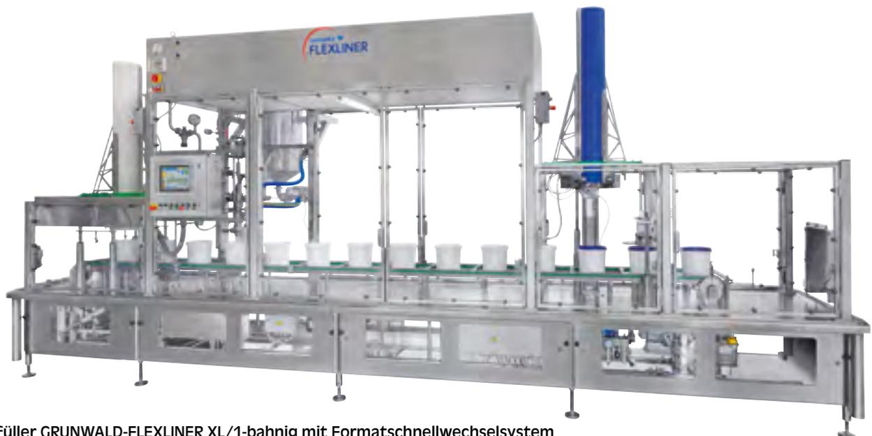
**Eimerfüller GRUNWALD-FLEXLINER XL/1-bahnig mit Formatschnellwechselsystem und selbstoptimierender Wiegeeinrichtung; Anlagenbreite: 1.000 mm, 1-bahnig, ca. 240 – 900 Eimer pro Stunde, Dosierbereich: 1 – 20 Liter**
