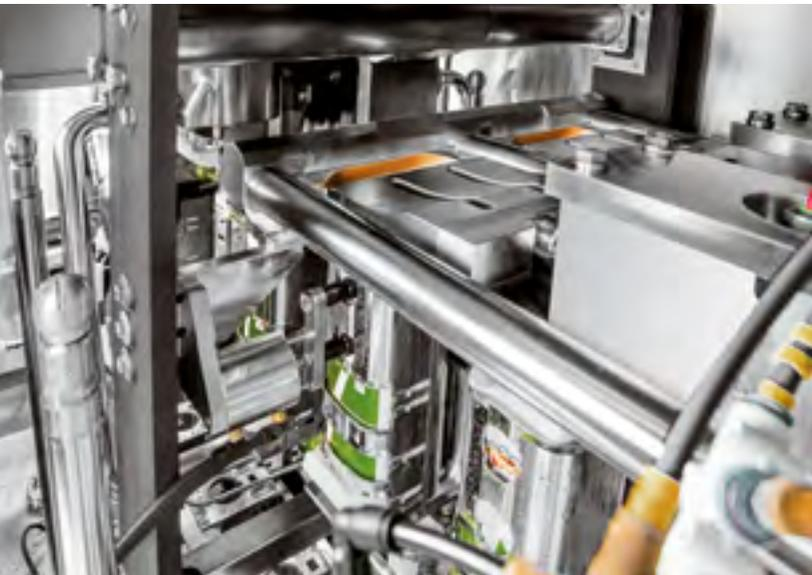
**Zweibahnige Abfüllanlage mit einer Produktionskapazität von mehreren Tausend Verpackungen pro Linie und Stunde. Jeweils zwei individuell arbeitende Siegelssysteme sind integriert. Die Bodennaht der Getränkekartons wird im Doppelnutzen mit je einer Titansonotrode dicht verschweißt. (Urheber: Telsonic)**
