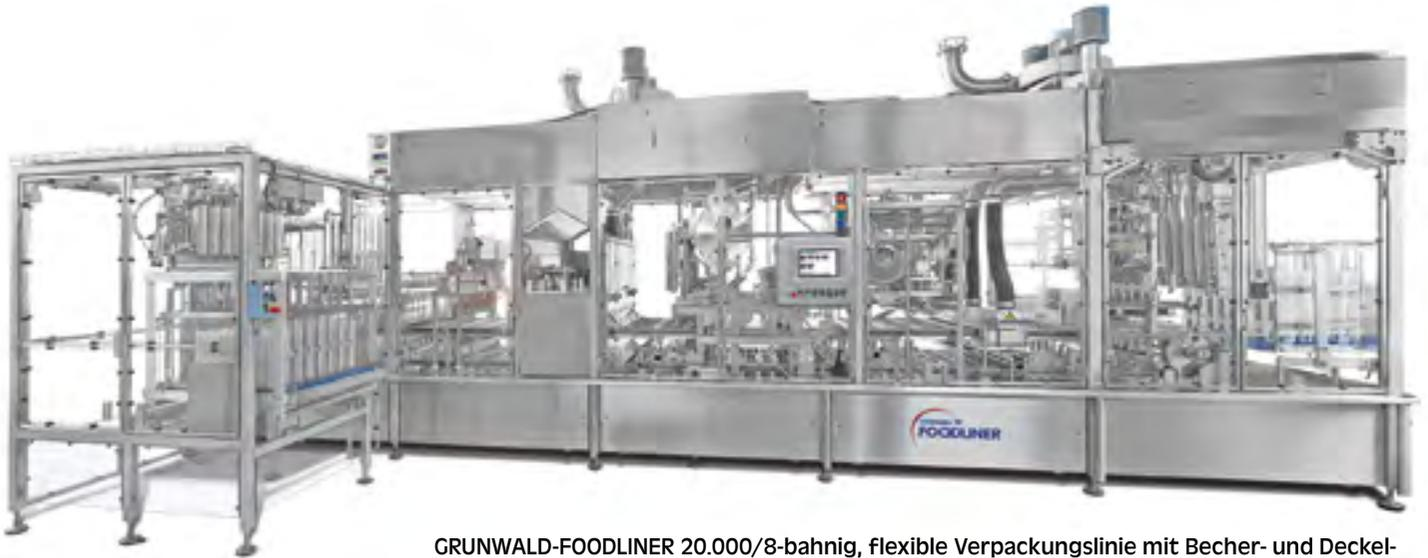
**GRUNWALD-FOODLINER 20.000/8-bahnig, flexible Verpackungslinie mit Becher- und Deckelsterilisation, ausgelegt für schnelle Formatwechsel- und Rüstzeiten, mit einer Produktionsleistung bis zu 20.000 Becher/h, ausgestattet mit CIP-fähiger Vor- und Hauptdosierung**
