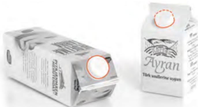
**Wiederverschließbare Verschlüsse werden mittels Ultraschall aufgeschweißt** (Urheber: Telsonic)
