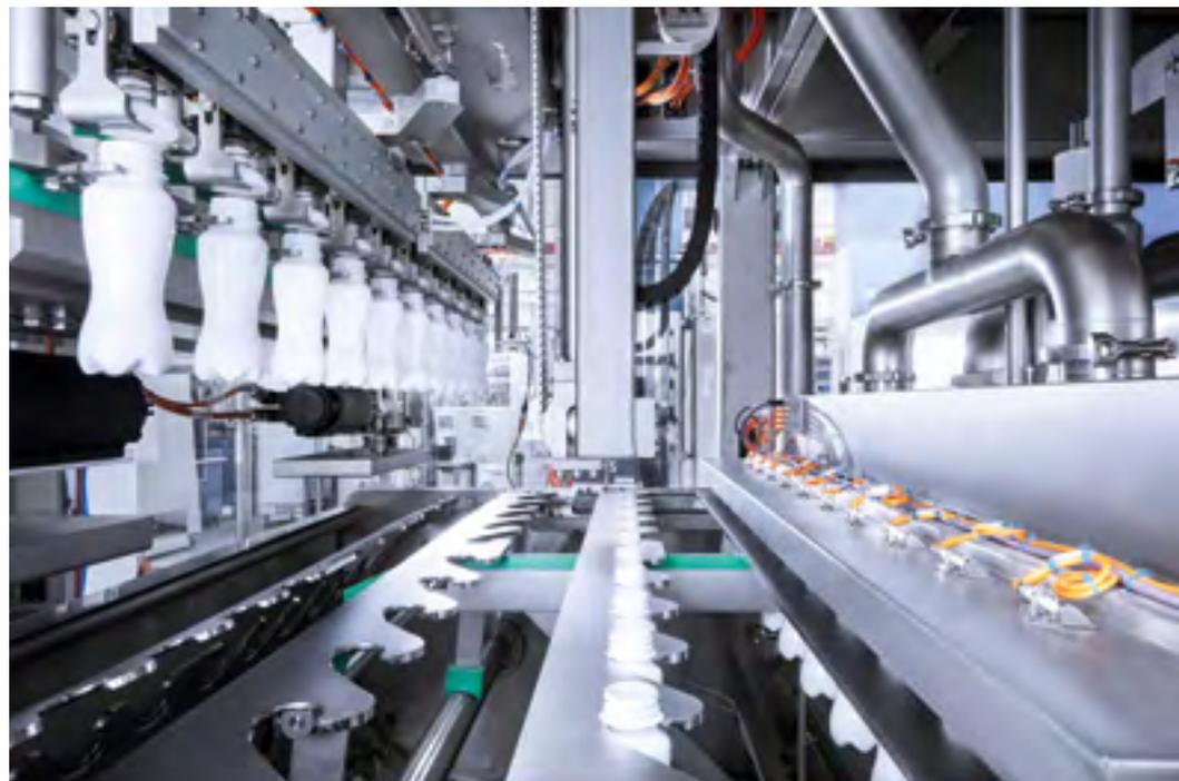
Der neue lineare Aseptik-Block InnoPET BloFill ABF von KHS ist für die Abfüllung von Milch, Milchmixgetränken sowie Säften, Smoothies und Eistee in PET-Flaschen mit Volumina zwischen 250 Milliliter und 2 Liter ausgelegt (Foto: KHS GmbH)
