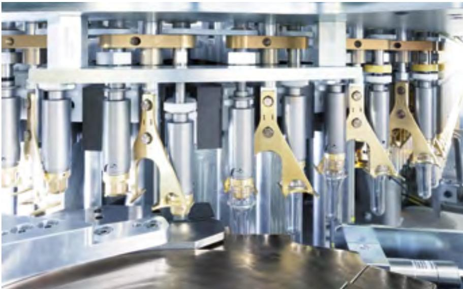
**Das Heizsystem der neuen Generation der Blomax-Serie verbraucht durch ein optimiertes Near-Infra-Red-Beheizungskonzept und die neue Doppelgassen-Technologie bis zu 40 Prozent weniger Energie im Vergleich zu den meisten herkömmlichen Heizsystemen (Foto: KHS GmbH)**
