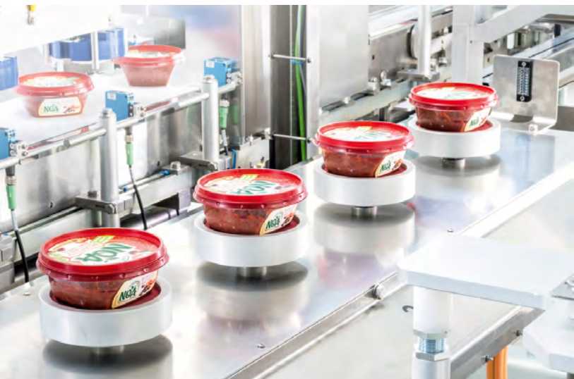
Mit Hilfe eines Schubert-Scanners, der das Wort NOA auf den Deckeln erkennt, werden die Produkte so ausgerichtet, dass der Schriftzug im Supermarkt für Kunden lesbar ist (Foto: Gerhard Schubert GmbH)
