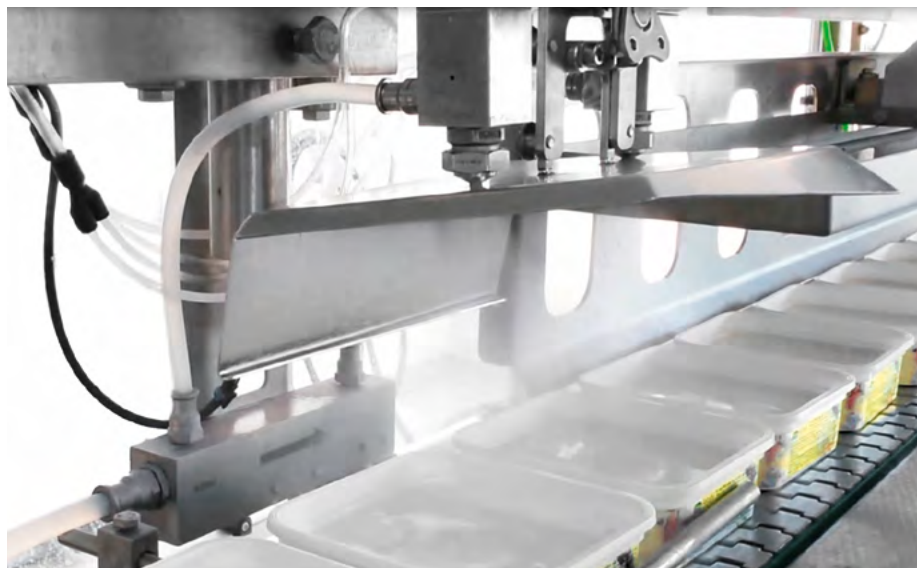
Sprühstation für Anti-Stick und Anti-Foam (Foto: GRUNWALD)
