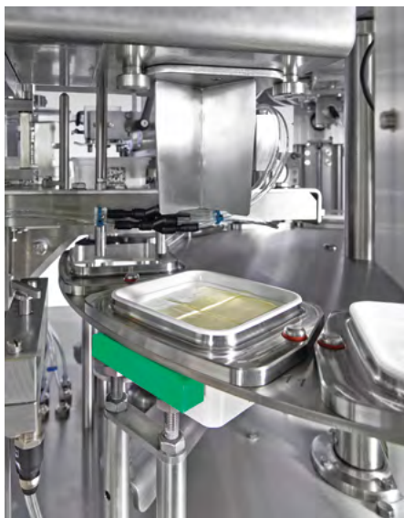
Käseschneidestation zur Teilung des Käses in 4 oder 6 Blöcke (Foto: GRUNWALD)
