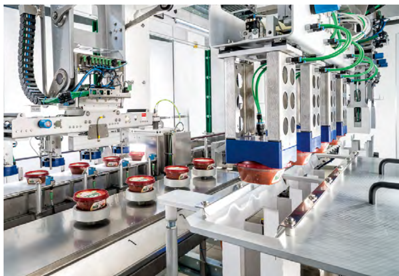
Die einzelnen Transmodule führen immer vier aufgerichtete Display-Kartons gleichzeitig zu, so dass jeder Karton bei jedem Füllvorgang jeweils einen Becher aufnehmen kann (Foto: Gerhard Schubert GmbH)
