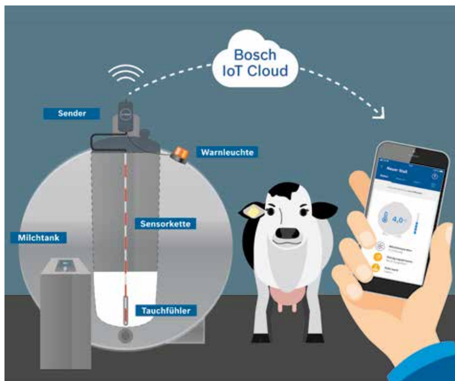
Deepfield-Connect-Milchüberwachung – Der vernetzte Tankwächter zum Nachrüsten: Mit optimaler Kühlung, direkter Temperaturmessung in der Milch und Alarmierung bei Fehlfunktionen des Tanks zu bester Milchqualität und Güteklasse (Foto: Bosch.IO)
