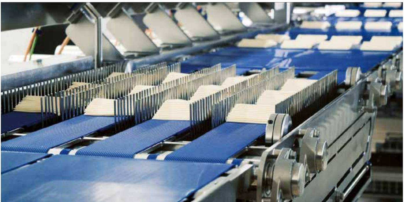
**Die exakte Anordnung der Schindel vermeidet Störungen an der Tiefziehmaschine (Foto: Schiwa)**
