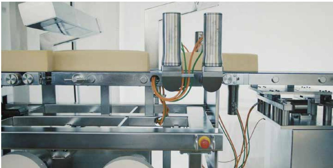
Über eine Wägung und eine geometrische Bestimmung ermittelt der Slicer die Dichte des Käses (Foto: Schiwa)
