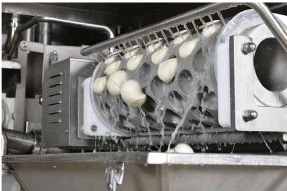
**Brimi Mozzarella in diversen Formen und Qualitäten ist die Spezialität des Milchhofes Brixen. Im Bild eine Trommelformmaschine („Rullo“) für Portionskugeln (Bild: Brimi)**
