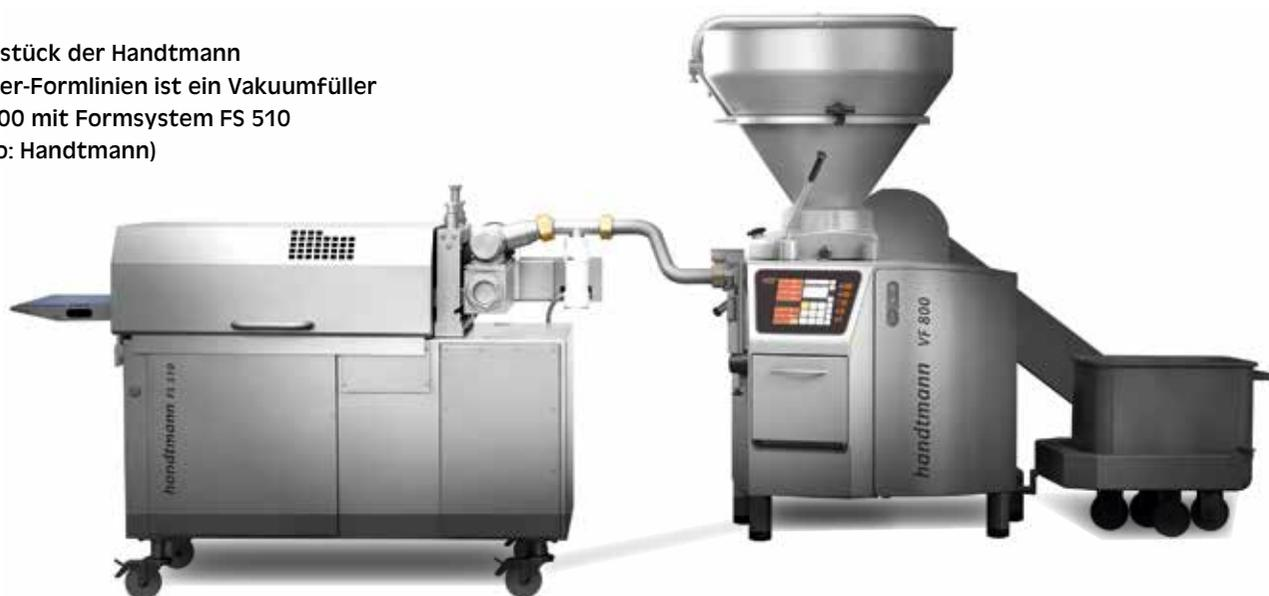
**H**andtmann bietet verschiedene Prozesslösungen für die Herstellung von Buttererzeugnissen. Das Formsystem 510 ist in Verbindung mit einem Vakuumfüller für die vollautomatische Herstellung von geformten Butterprodukten unterschiedlichster Querschnitte geeignet und bietet damit auch Spielraum für neue Produktideen.
