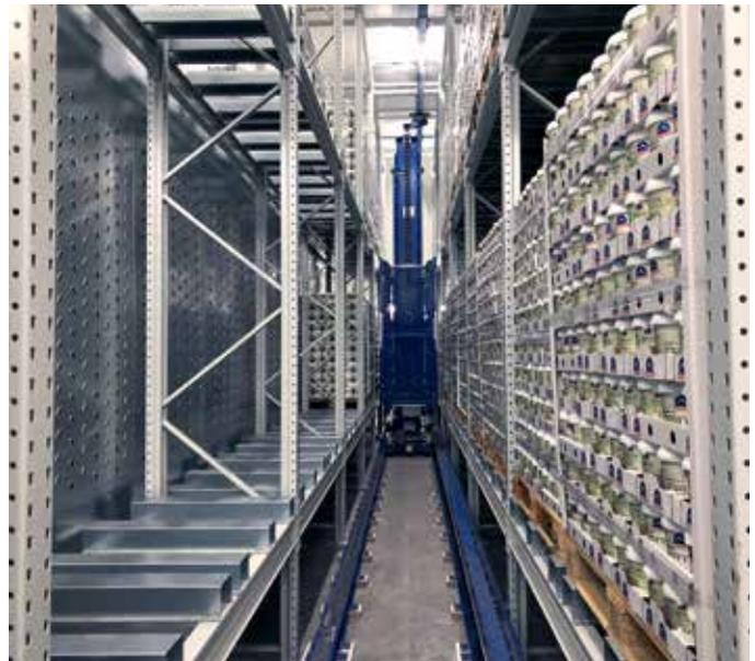
**airinotec AccuCool: Flexible Palettenkühlung auf zwei Ebenen (Foto: airinotec)**
