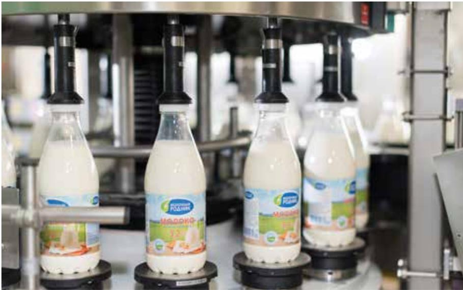
Eine Rundum-Etikettiermaschine Contiroll stattet die Behälter aus. Alternativ kann der Betrieb eine Sleeve-Etikettiermaschine Sleevematic nutzen
