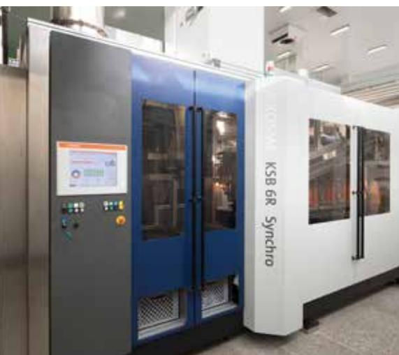
Der Aseptik-Block PET-AseptBloc D mit  $H_2O_2$ -Entkeimung besteht aus Streckblasmaschine Kosme KSB 6R Synchro und Füller Modulfill Asept VFJ mit aseptischem Verschießer
