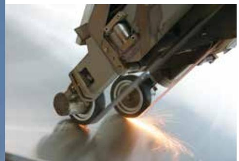
Abbildung 2: Durch zusätzliche Maßnahmen wie mechanisches Polieren lassen sich Rautiefen der produktberührten Oberflächen weiter verringern
