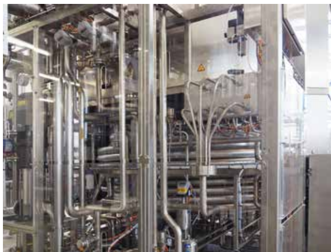
Jedes der sieben Innenrohre im Erhitzer ist separat spülbar
