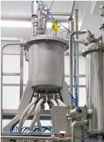
VEGA-Sensoren kontrollieren den Füllstand, damit die Abfüllung des Joghurts reibungslos abläuft
