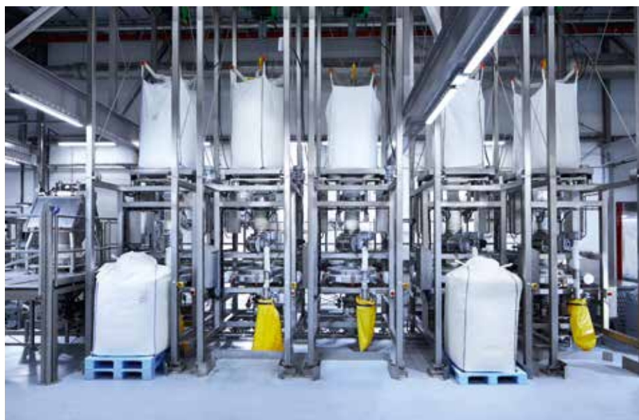
DMK Baby in Strückhausen: Verwogene Big-Bag Entleerstation mit integriertem Vibrationssieb für Rohstoffe die in Milch aufgelöst werden (Fotos: Derichs)
