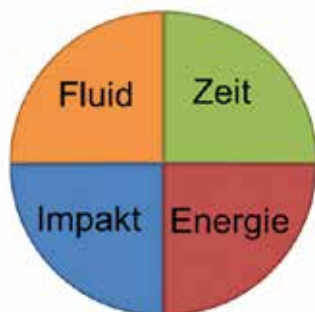
Abbildung 1: Sinnerscher Kreis mit Prozessparameter einer Reinigung: Fluid(menge), Einwirkzeit, Aufprall Impuls, und Energie/Temperatur
