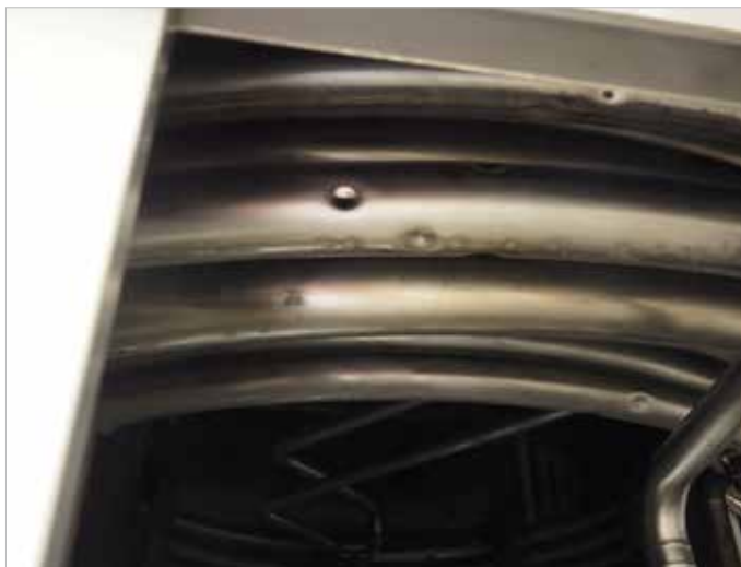
Definiert gesetzte Prägungen halten die Innenrohre auf Abstand
