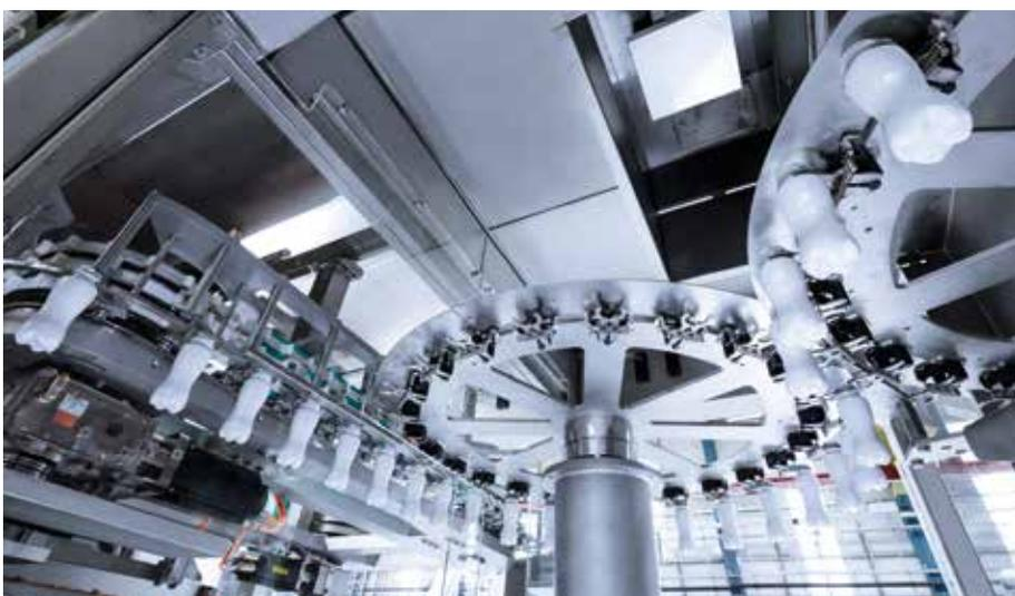
Dank der Verblockung von Streckblasmaschine und Linearfüller minimiert der Systemanbieter ein mögliches Einschleppen von Verschmutzungen. Das wirkt sich positiv auf die Hygiene und Anlagenverfügbarkeit aus. (Foto: KHS GmbH)
