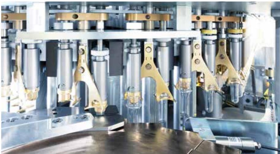
Das Heizsystem der neuen Generation der Blomax-Serie verbraucht durch ein optimiertes NIR-Beheizungskonzept und die neue Doppelgasen-Technologie bis zu 40 Prozent weniger Energie im Vergleich zu den meisten herkömmlichen Heizsystemen. (Foto: KHS GmbH)
