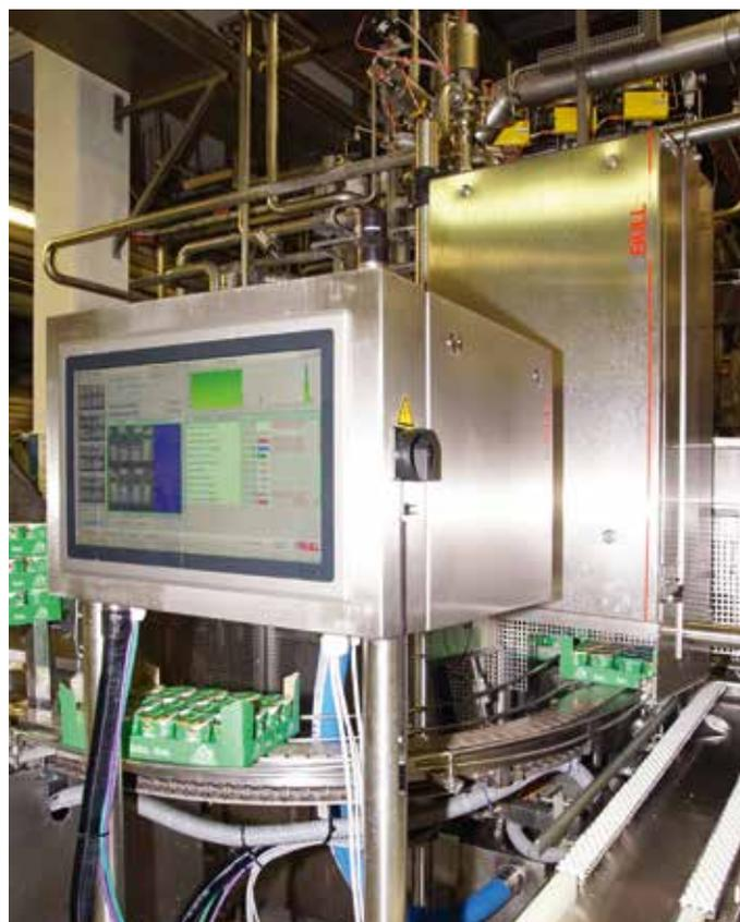
Das System „BBull Tray Inspektion“ mit der Platinen-Kontrolle und dem Display, die Kontrolle der Becher findet auf der anderen Seite der Maschine statt (Foto: broesele)
