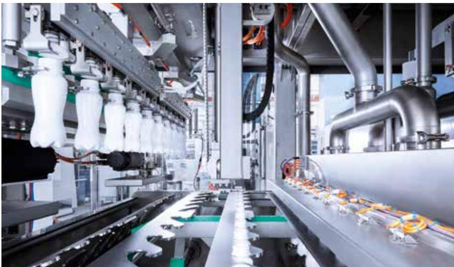
Der neue lineare Aseptik-Block InnoPET BloFill ABF von KHS ist für die Abfüllung von Milch, Milchmischgetränken sowie Säften, Smoothies und Eistee in PET-Flaschen mit Volumina zwischen 250 Milliliter und 2 Liter ausgelegt. (Foto: KHS GmbH)
