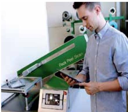
„Pack Peel Scan“ überprüft normgerecht die Öffnungskräfte thermogeformter, peelbarer Verpackungen. Die maschinelle Lernmethode ermöglicht zusätzlich die Prognose und Vermeidung von Prozessfehlern (Foto: Fraunhofer IVV)
