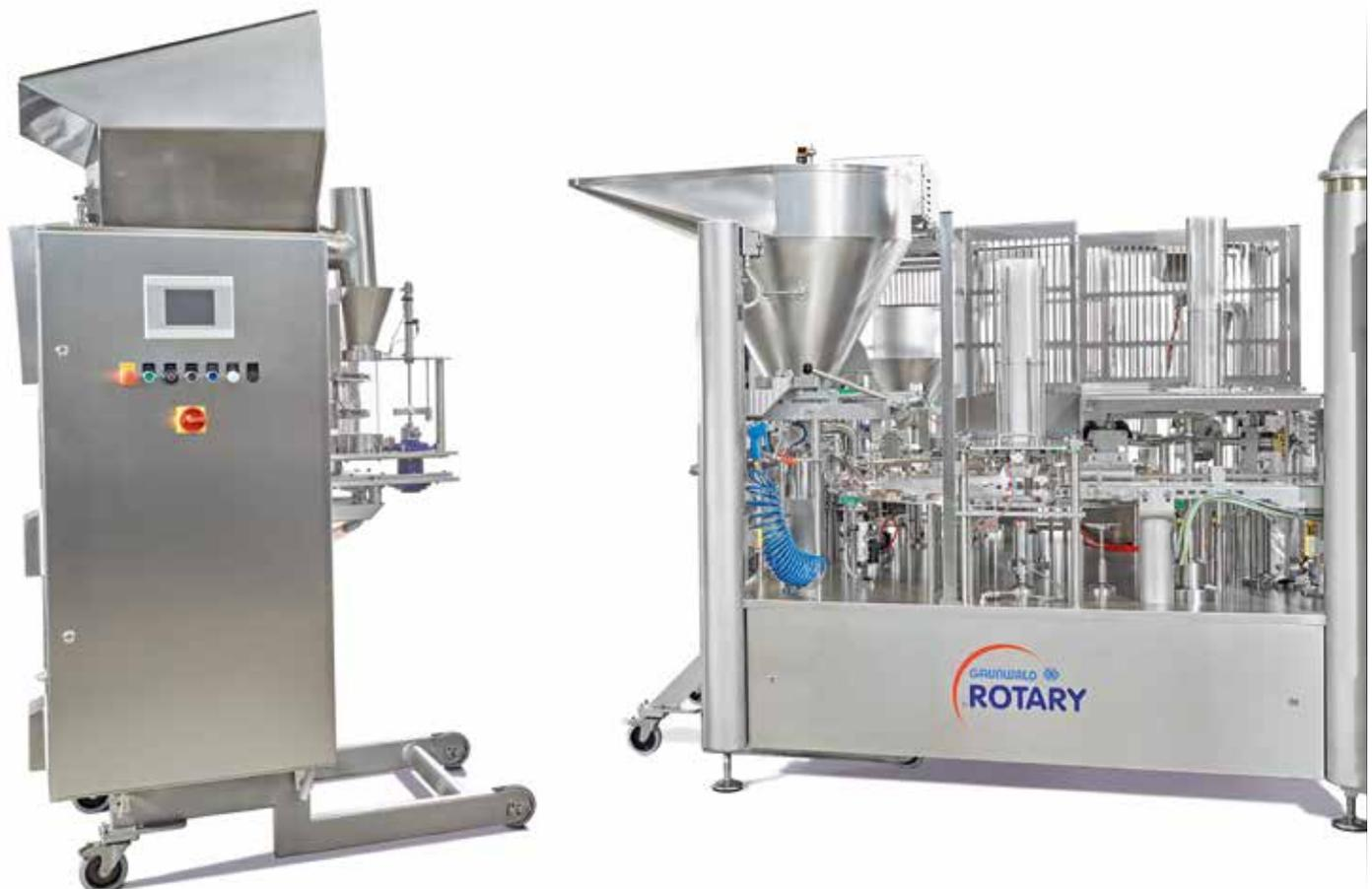
GRUNWALD-FLEXODOS (links im Bild) für nicht pumpfähige, rieselfähige Produkte in Warteposition; in der Dock-In-Station der Becherfüllanlage GRUNWALD-ROTARY 12.000 ist der mobile Kolbendoseur für pumpfähige Produkte Typ Mobifill angedockt
