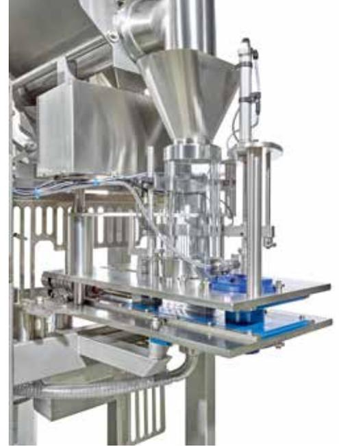
**Der mobile Schüttgutfüller arbeitet auf der Basis der Volumendosierung. Dieses Funktionsprinzip garantiert auch nicht pumpfähigen Produkten eine produktschonende Abfüllung**
