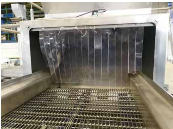
Alle kritischen Maschinenteile sind aus Edelstahl gefertigt und bieten so ein Höchstmaß an Hygiene (Foto: H. F. Meyer Maschinenbau)
