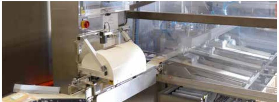
**Die Käseverpackungen laufen an dieser Station von links kommend unter dem Bildverarbeitungssystem hindurch und werden nach der Inspektion von einem Roboter in Transportkisten abgelegt (Foto: Kaiser engineering)**
