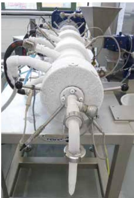
**Aufbau eines Planetwalzenextruders**
