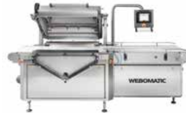
CL-C 950: Die Kammerbandmaschine beeindruckt mit ihrem hygienischen Design (Bsp. patentierte Deckelkonstruktion) und der Möglichkeit unterschiedlich große Produkte, wie z. B. Käseblöcke (15–20 kg) in einem Arbeitsgang für den Transport zu verpacken
