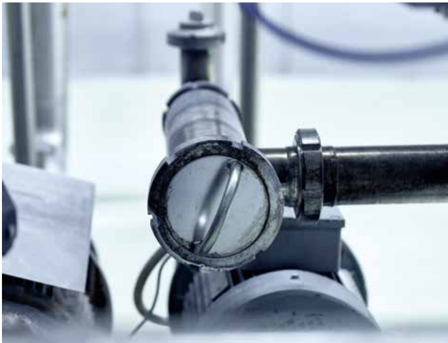
Anlagenbediener müssen nach der CIP das Eckrohrsieb zur Kontrolle oder Reinigung öffnen – hier lauern Unfälle
