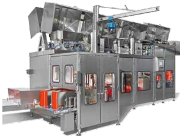
GRUNWALD-ERGOLINER XL – der neue Längsläufer-Eimerfüller mit ergonomischem Ultra-Clean-Design
