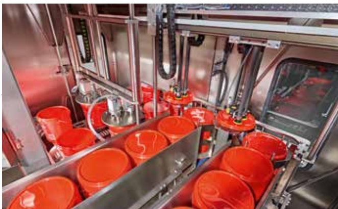
Die Stülpedeckel werden exakt auf den Eimern abgelegt und anschließend funktionssicher aufgedrückt
