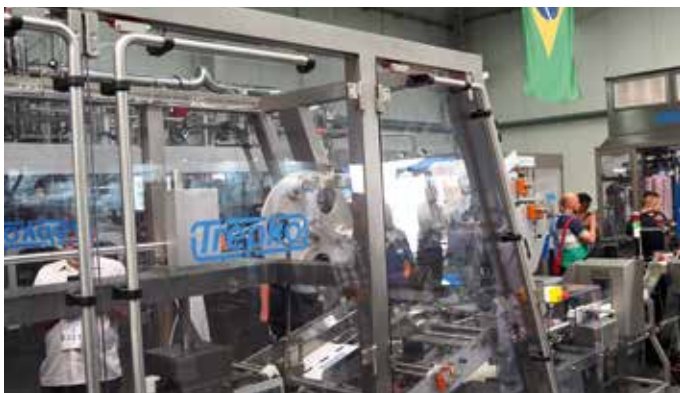
Gezeigt wurde unter anderem eine Linie aus Zutatenmischer (Zentis), Rundläufer-Becherfüller und End-of-Line Wrap-around-Packer, auf der Kefir mit Zusätzen produziert wurde
