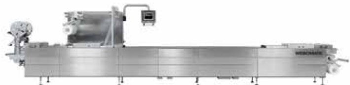
ML-C 7600: Die Hochleistungstiefziehmaschine ML-C 7600 ist vielseitig einsetzbar, z. B. für die Verpackung von Käsestücken bis hin zu Käseaufschnitt
