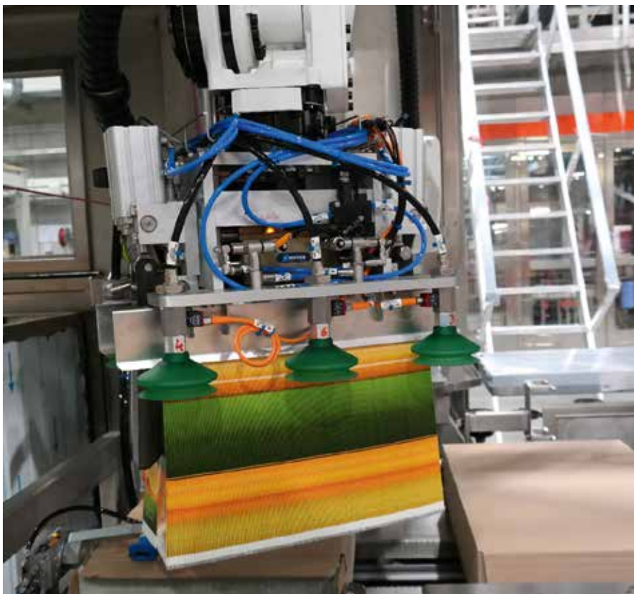
Die Beladeautomatik Elopak Blank Loader sichert bei der Bestückung des Füllers mit Zugschnitten einen Puffer von eineinhalb Stunden Produktionszeit
