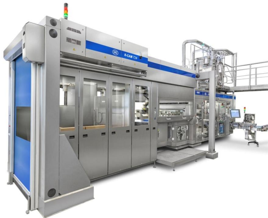
*Mit dem neuen Robotic Magazine (R-CAM) für Highspeed-Füllmaschinen bietet SIG Combibloc Kunden eine entscheidende Komponente auf dem Weg hin zu mehr Automation. Das neue R-CAM bestückt die Füllmaschine vollautomatisch mit Packungsmänteln – ein echter Gewinn, was die Effizienz der Arbeits-abläufe die Reduktion des manuellen Arbeitsaufwandes. Foto: SIG Combibloc*
