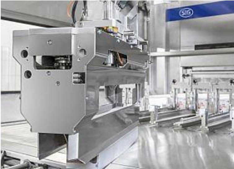
Mit dem *Robotic Magazine* wurde ein vollautomatisches Magazin entwickelt. Dabei werden die Umkartons von der Palette genommen und die Füllmaschine wird mit Packungsmänteln bestückt. folgt vollautomatisch – es ist kein manuelles Eingreifen seitens des Personals nötig. Foto: SIG Combibloc
