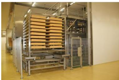
Jeder der Reiferäume in Spielberg, die alle gleich groß sind, ist als Blocklager konzipiert, das in Längsrichtung von einem Mittelgang durchzogen wird. Vom Mittelgang aus werden die Reifegestelle, in denen die Käselaibe und -blöcke auf Holzbrettern auf zehn Ebenen untergebracht sind, rechtwinklig zu beiden Seiten in parallelen Reihen abgestellt. Dabei stehen die Gestelle, die jeweils eine Charge darstellen, dreifach hintereinander und dreifach hoch.
