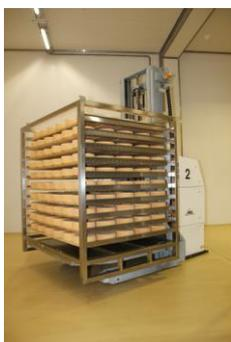
Die Bedienung des Kühl- und Reifelagers übernehmen zwei – dank bewährter Magnetnavigation frei verfahrbare – Transportfahrzeuge (FTF) von MLR. Es handelt sich dabei um dreirädrige Radarmstapler vom Typ Phoenix SS-3.4 Mr mit einer Hubplattform als Lastaufnahmemittel mit 3,35 Tonnen Tragfähigkeit und einer Hubhöhe von 4.770 mm. Die FTF sind in der Lage, die Gestelle selbstständig von den Übergabepositionen durch Unterfahren der Gestelle
