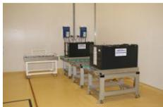
Die gesamte Anlage, in der pro Stunde rund 3.600 Käselaibe und -blöcke behandelt werden, ist so ausgelegt, dass sie rund um die Uhr arbeiten kann. Daher gehört zum System auch eine Ladestation, ausgestattet mit zwei Ladegeräten und einem Batteriewechselwagen zum Tauschen der entladenen gegen eine geladene 630-Ah-Bleibatterie. Der Tausch geschieht manuell in weniger als fünf Minuten.
